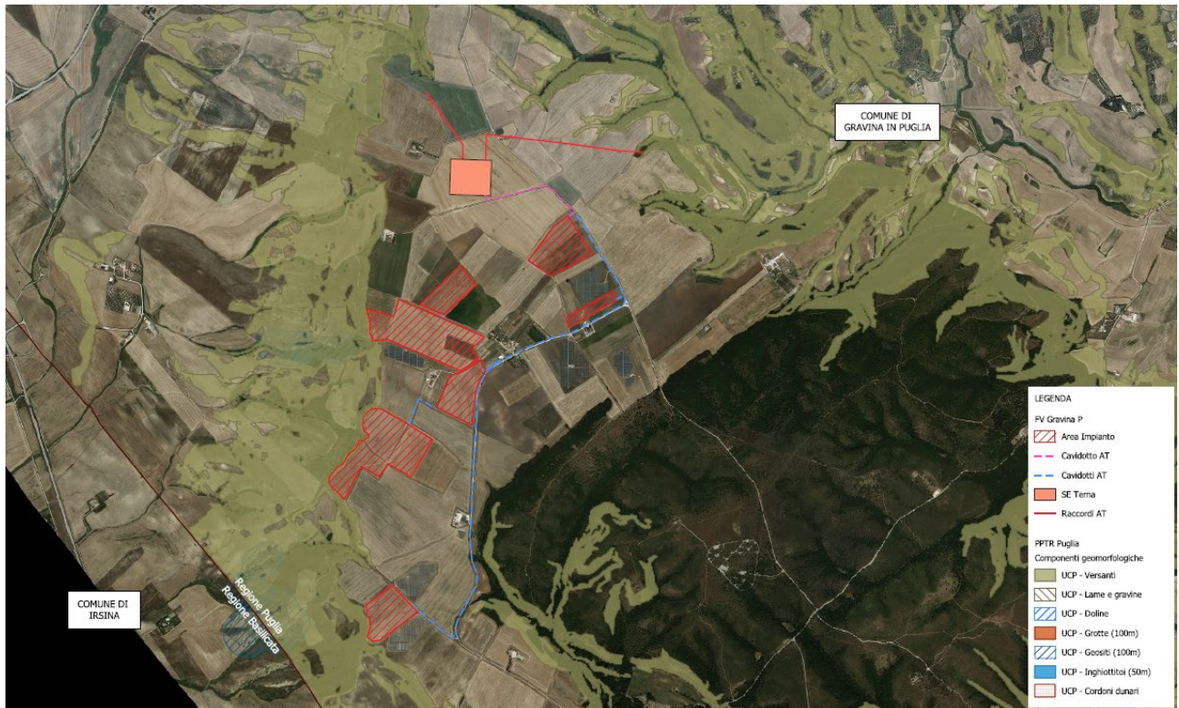
Figura 13-5: Tav ALL_03 Componenti geomorfologiche - individuazione di BP e UCP nell'area di impianto
