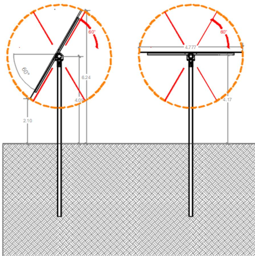
Figura 5-4: Sezione tipo struttura porta pannelli
