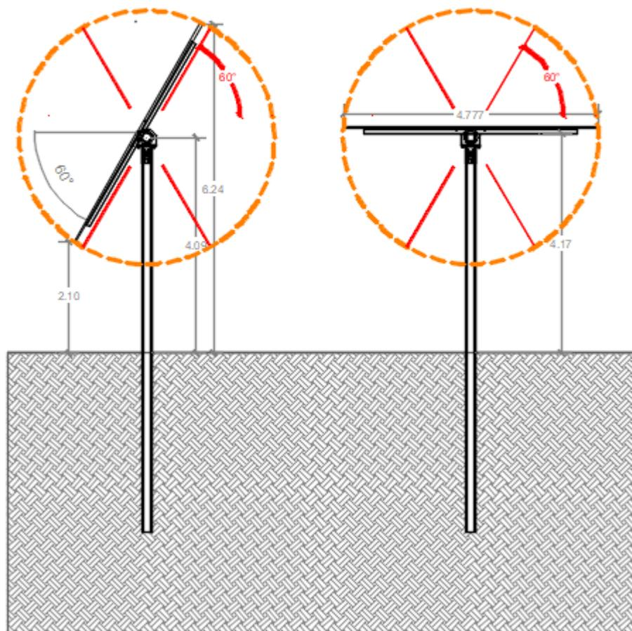
Figura 2-2: Sezione tipo struttura porta pannelli
