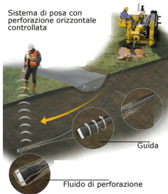
FIG 12 Sistema di trivellazione orizzontale controllata (T.O.C.).
