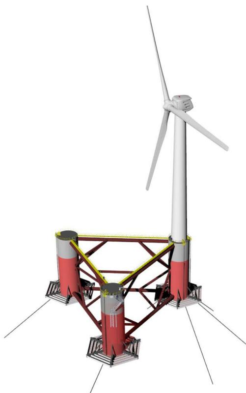
*Figura 22: configurazione semisommersibile WindFloat da 2 MW [17] - la configurazione semisommersibile da 15 MW proposta in questo rapporto si basa su questa e su simili di dimensioni maggiori (vedi sezione 6.2.1)*
