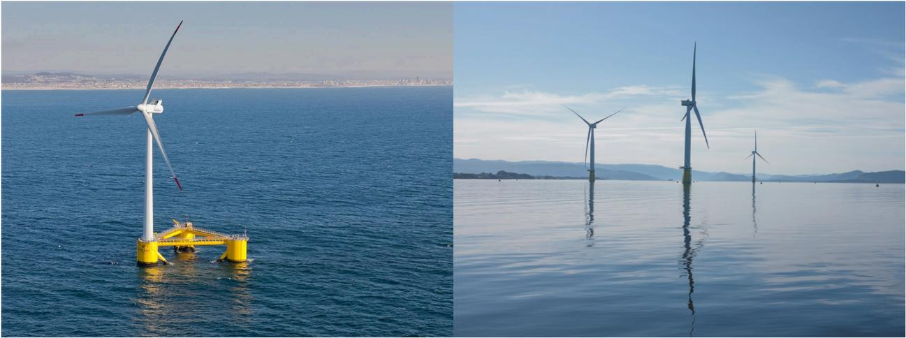
Figura 16: (a sinistra) semisommersibile<sup>7</sup> di Principle Power, (a destra) spar di Hywind<sup>8</sup>
