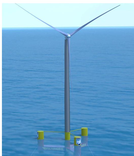
*Figura 1: L'aerogeneratore offshore di riferimento IEA Wind 15 MW (si noti che, per il presente lavoro, sono state considerate solo le caratteristiche della torre e del gruppo rotore-navicella – non della sottostruttura) [1]*
