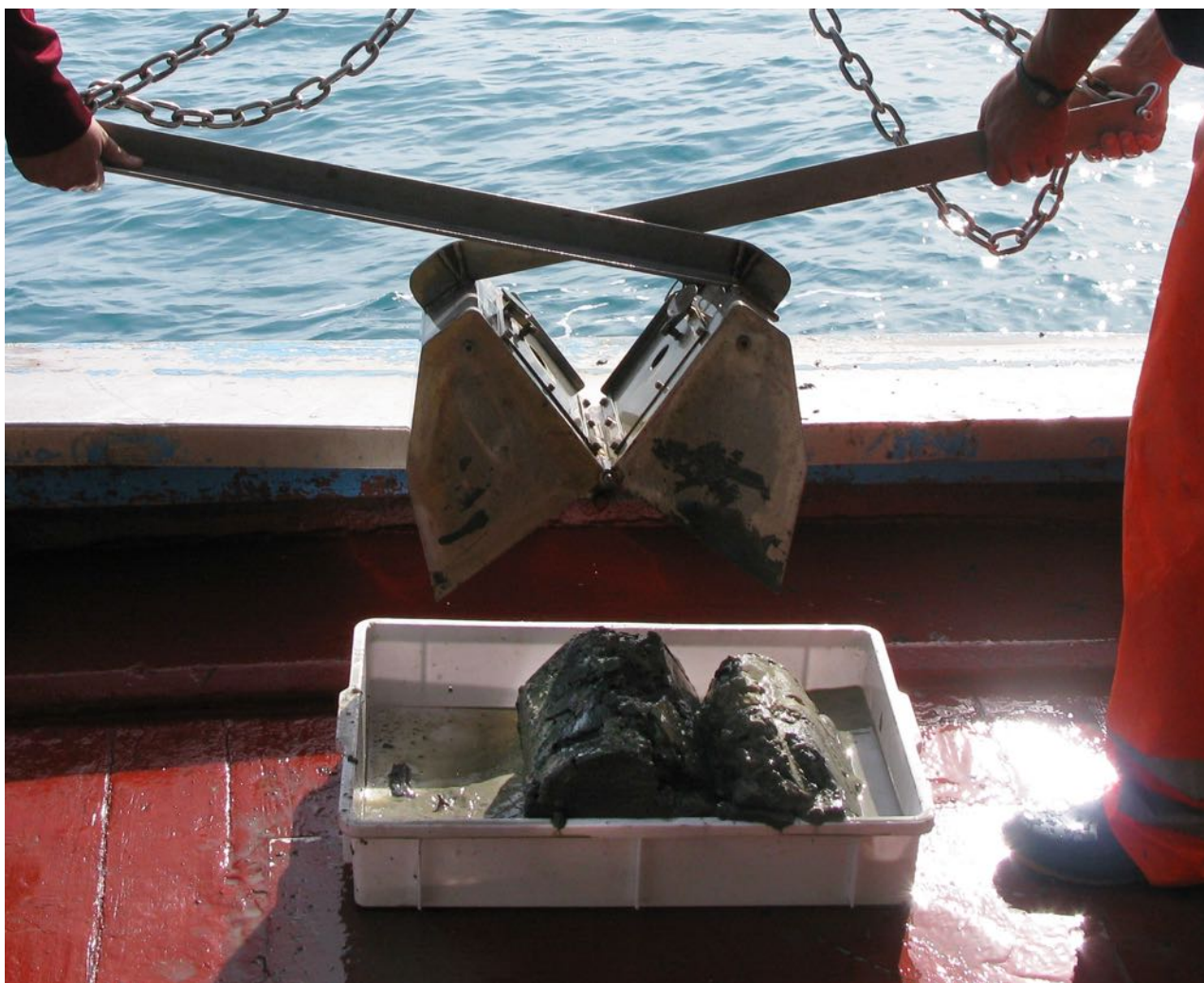
Fig. 3.D – Benna van Veen con capacità di 20 litri utilizzata per il prelievo dei campioni di sedimenti e macrozoobenthos.
