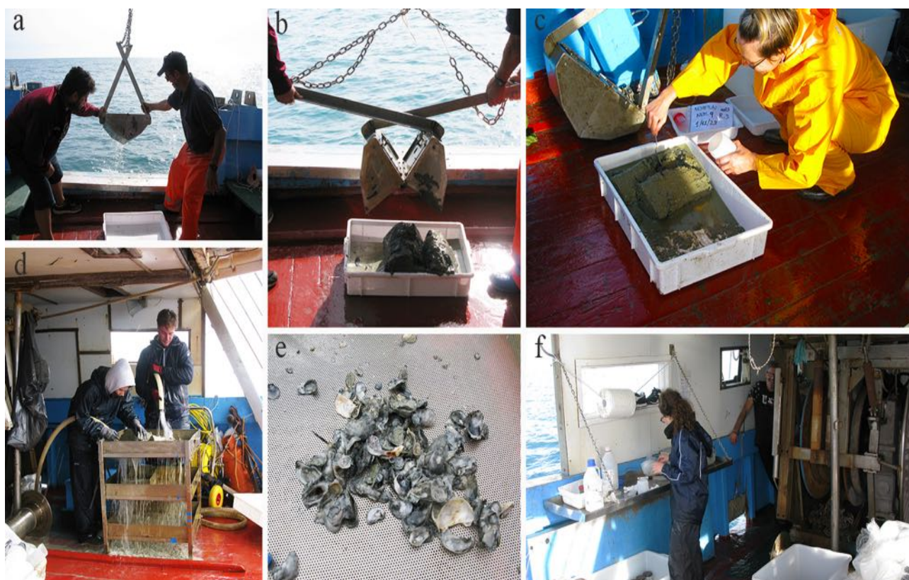
Fig. 5.1.1.A – Fasi del campionamento del sedimento e del macrozoobenthos. A) Salpaggio della benna van Veen; b) svuotamento del contenuto della benna in vasche di plastica; c) prelievo dei campioni di sedimento per le analisi chimiche, fisiche ed ecotossicologiche; d) setacciatura su tavolo a setacci multipli; e) materiale biologico raccolto; f) conservazione in alcol al 70% ed etichettatura del materiale biologico.
