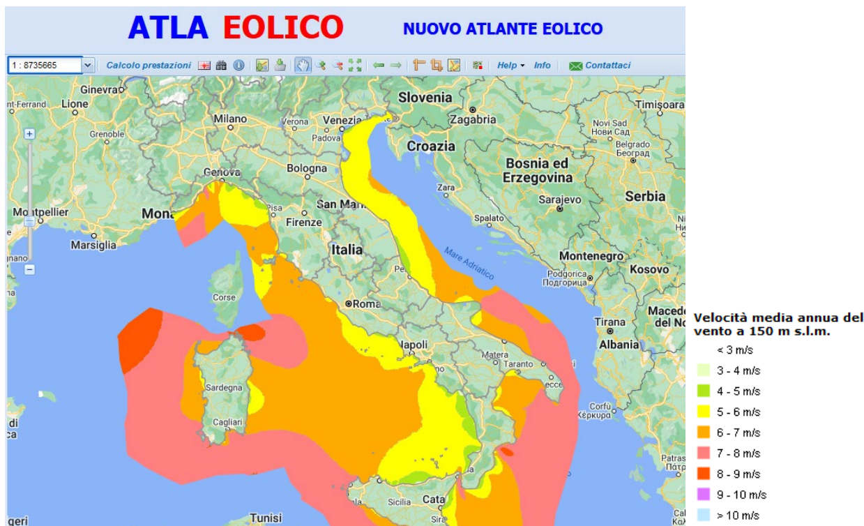
Velocità media annua del vento a 150 m – tratta dall'atlante eolico della società RSE SpA
