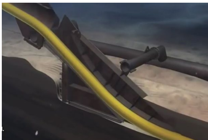
Aratro marino e schema tridimensionale della trincea di scavo
