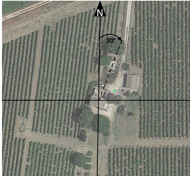
Figura 3-8 Esempio di identificazione dell'orientamento delle finestre dei recettori
