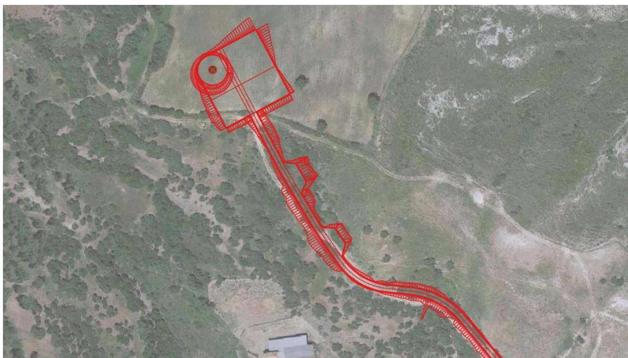
Figura 7-10 – Esempio di layout piazzola per aerogeneratore UBR01
