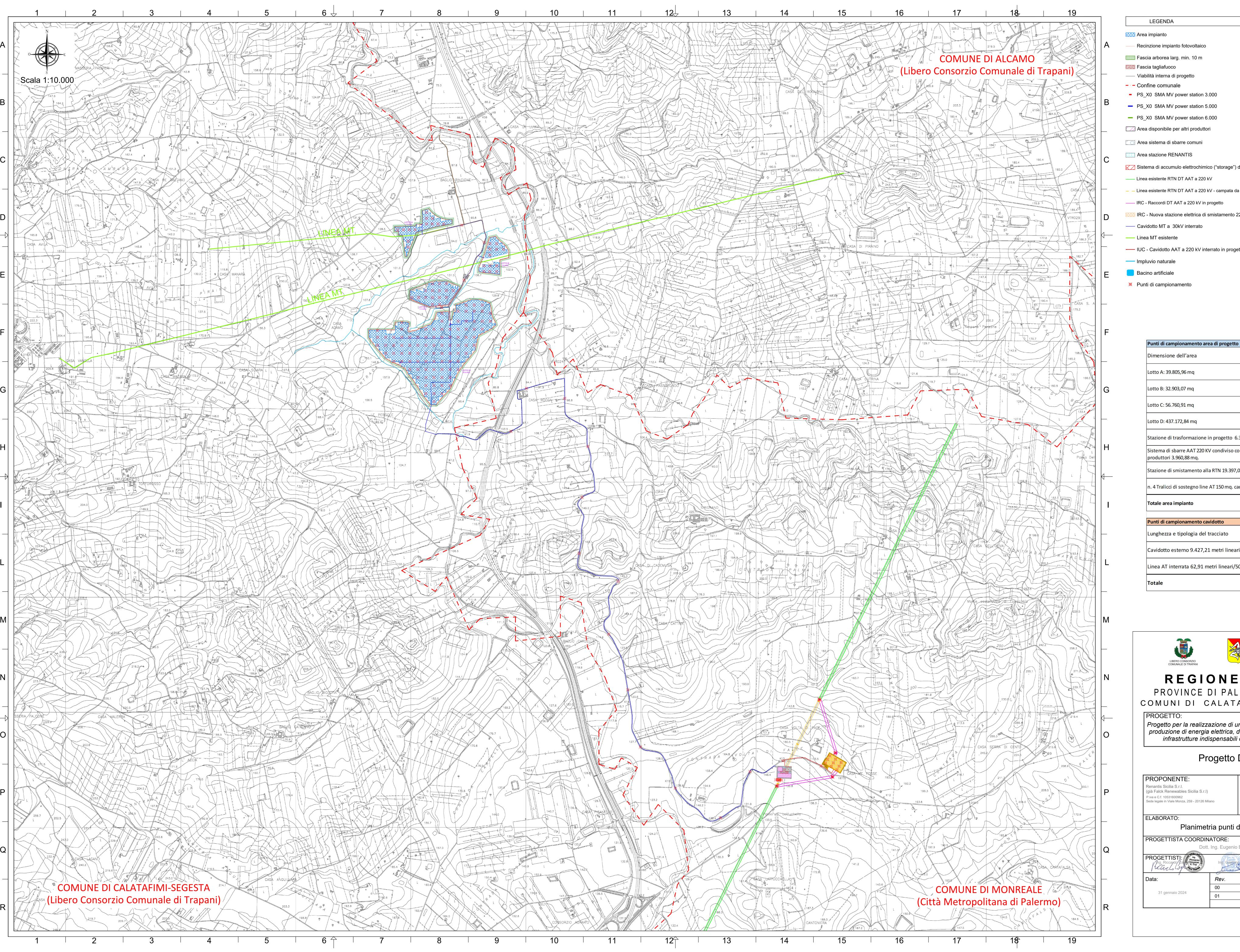
Recinzione impianto fotovoltaico Fascia arborea larg. min. 10 m Viabilità interna di progetto PS\_X0 SMA MV power station 3.000 PS\_X0 SMA MV power station 5.000 PS\_X0 SMA MV power station 6.000 Area disponibile per altri produttori Area sistema di sbarre comuni —— Linea esistente RTN DT AAT a 220 kV Linea esistente RTN DT AAT a 220 kV - campata da demolire — IRC - Raccordi DT AAT a 220 kV in progetto — Cavidotto MT a 30kV interrato IUC - Cavidotto AAT a 220 kV interrato in progetto
