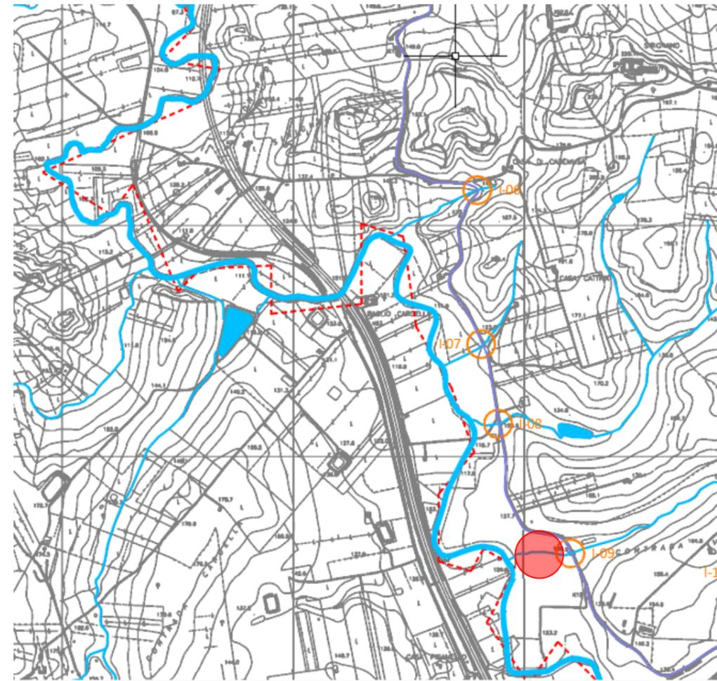
Figura 27. Stralcio della Tavola "Planimetria delle interferenze con rete idrografica" - interferenza passaggio del cavidotto MT (rosso) in C.da Volta di Falce
