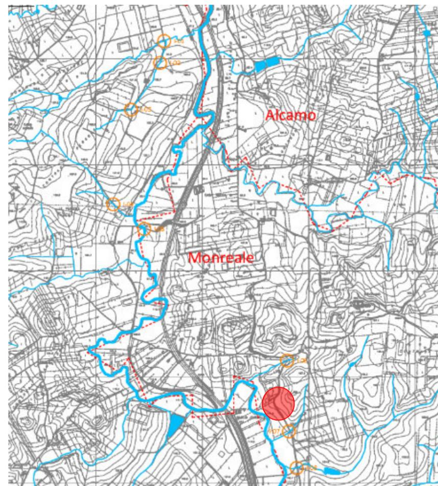
Figura 23. Stralcio della Tavola "Planimetria delle interferenze con rete idrografica" - interferenza passaggio del cavidotto MT (rosso) in C.da Baglio Cardella
