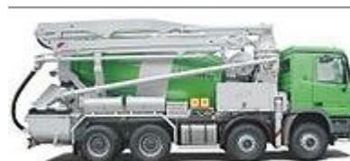
Questa soluzione viene utilizzata qualora si debbano usare quantità abbondanti di cemento in un cantiere che non è dotato di una betoniera fissa. Il bicchiere viene mantenuto in rotazione durante il trasporto; giunto in cantiere viene fatto ruotare in senso opposto e, sfruttando una coclea, il cemento risale le pareti e può fuoriuscire dalla sommità per essere gettato in opera.
