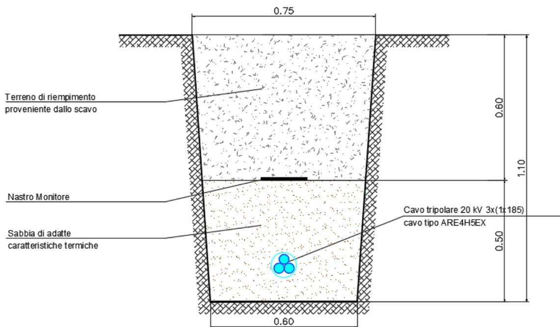
Figura 53: Sezione tipo di scavo su terreno agricolo
