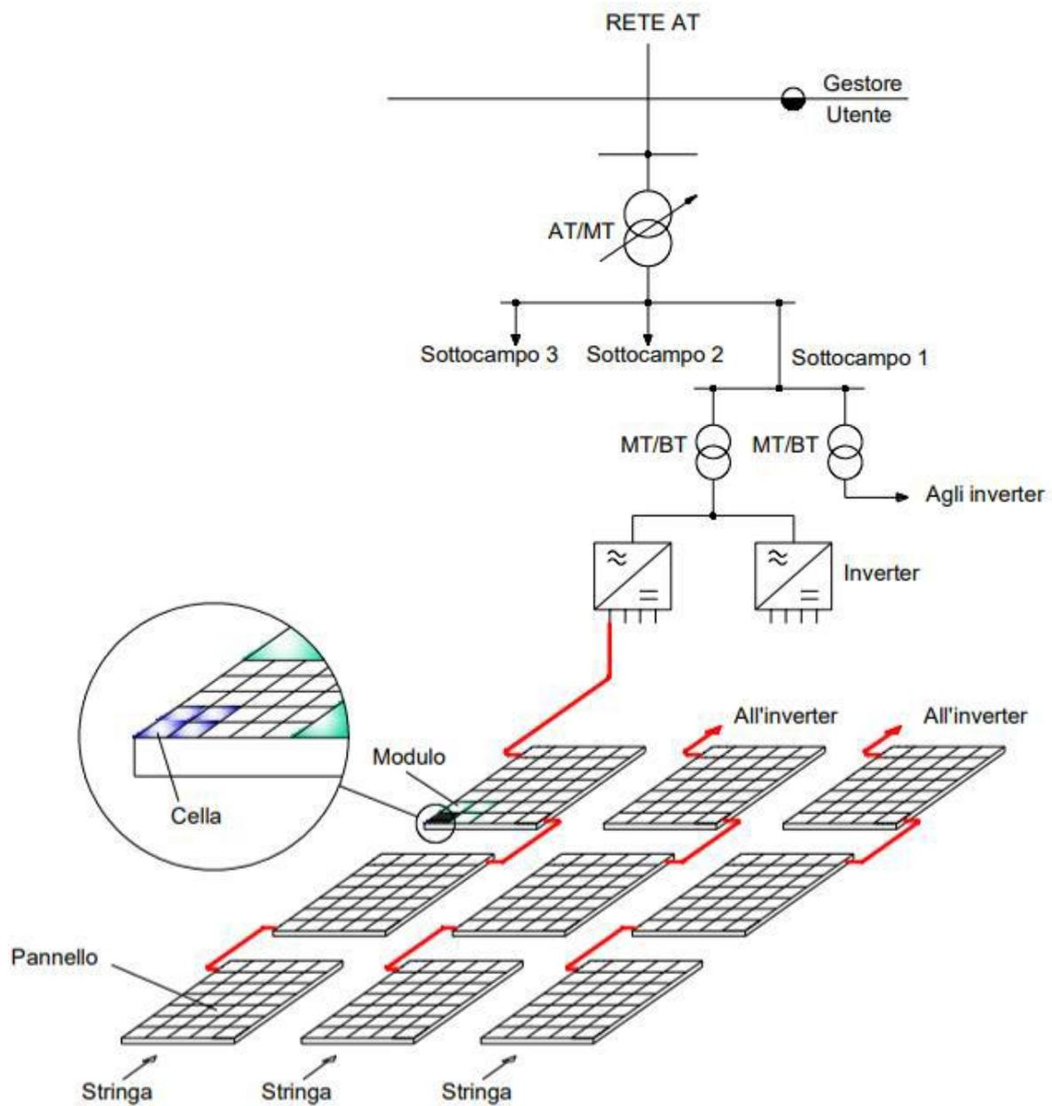
Figura 49: Schema funzionale dell'impianto fotovoltaico
