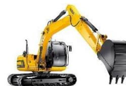
Per consentire il suo spostamento, un escavatore deve essere montato su un telaio che ne permetta il movimento. Il peso oscilla da poco meno di 50 quintali (per i miniescavatori) sino alle 80 tonnellate (per gli escavatori).
