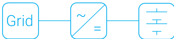
Figura 13 Schema semplificato di un convertitore monostadio
