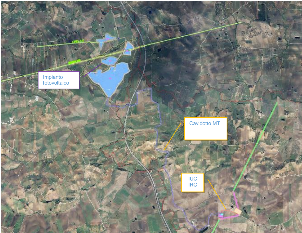
Figura 1.2 inquadramento impianto in progetto
