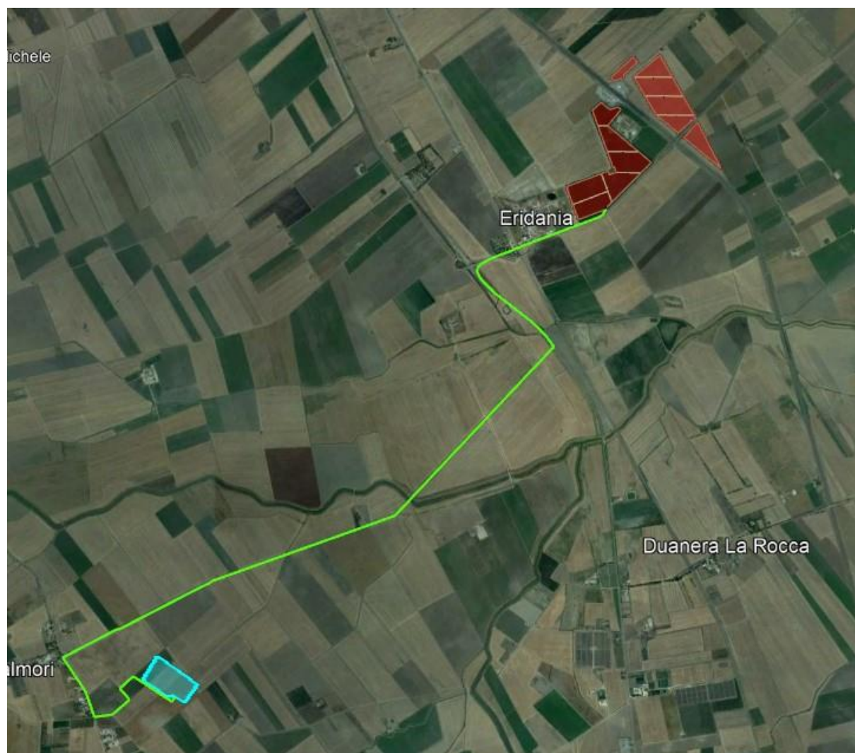
Figura 4.2: Soluzione di Connessione alla SE - In verde il percorso di connessione dal campo FV (aree rossa) al futuro ampliamento della SE (area azzurro).
