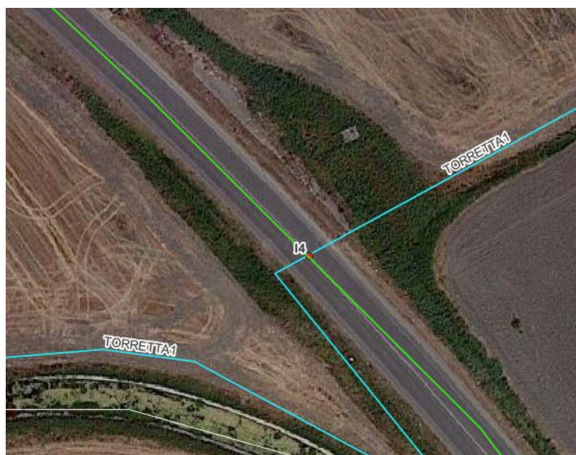
Figura 5.11: Ubicazione interferenza I4. In verde la linea di connessione e in azzurro il reticolo idrografico.
