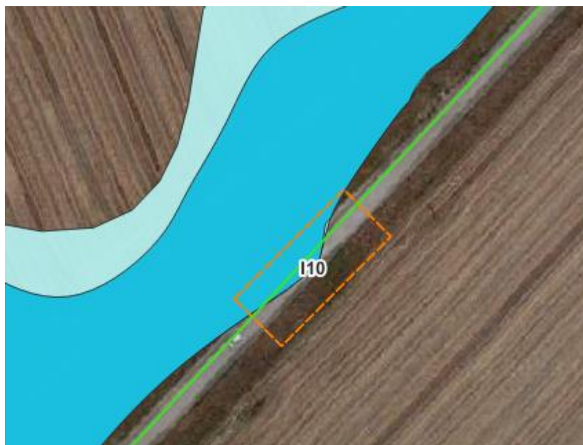
Figura 5.27: Stralcio PGRA. In arancione tratteggiato il tratto della linea di connessione in area allagabile I10 con pericolosità media, bassa. In verde la linea di connessione.
