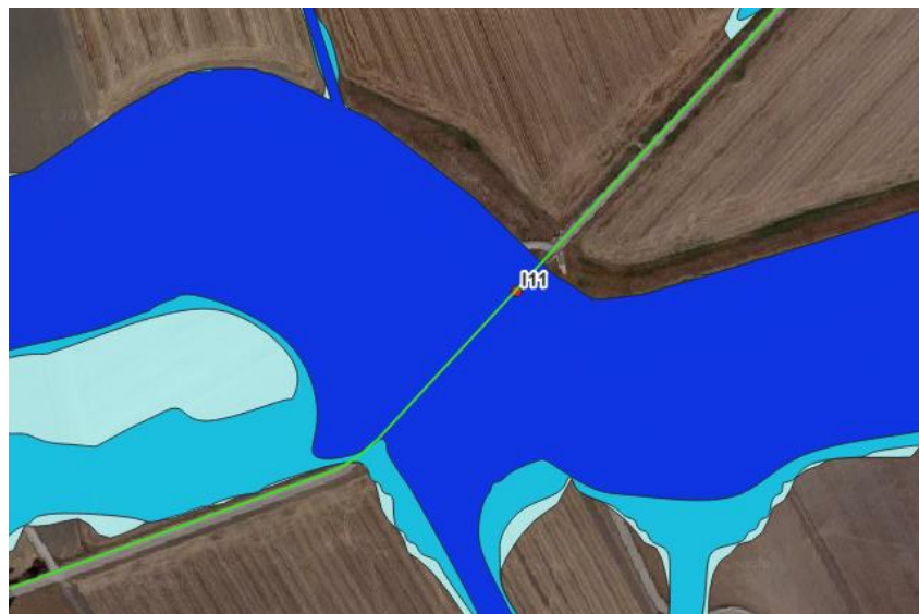
Figura 5.30: Ubicazione dell'interferenza I11 e stralcio PGRA con pericolosità alta. In verde la linea di connessione.
