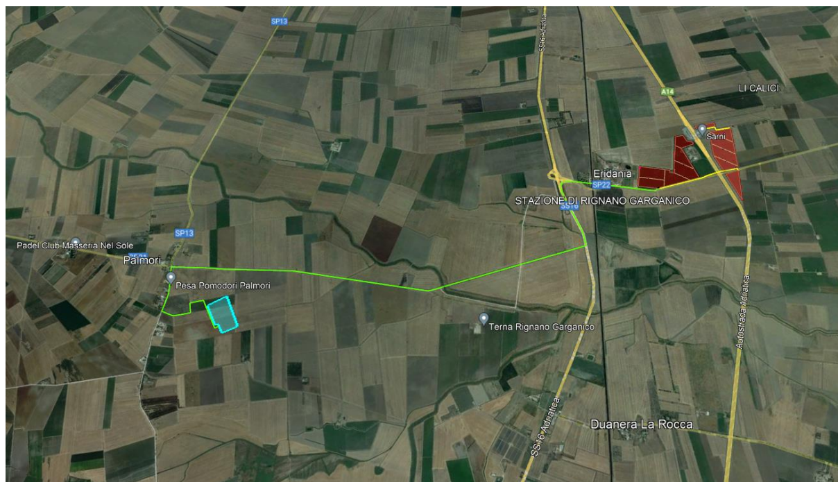
Figura 5.1 - Soluzione di Connessione alla SE - In verde il percorso di connessione dal campo FV (aree rossa) al futuro ampliamento della SE (area azzurro)
