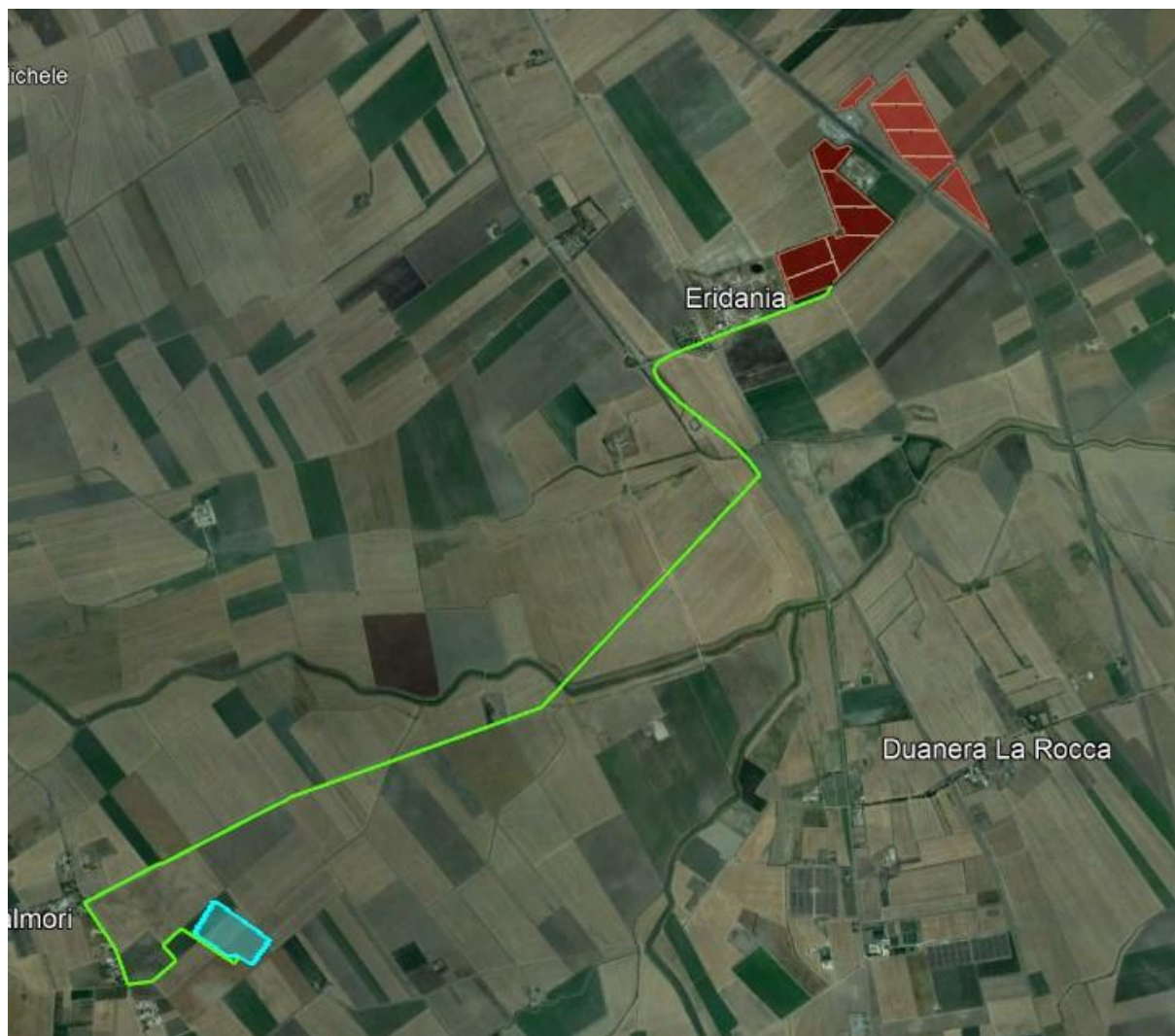
Figura 2.12: Soluzione di Connessione alla SE - In verde il percorso di connessione dal campo FV (aree rossa) al futuro ampliamento della SE (area azzurro)
