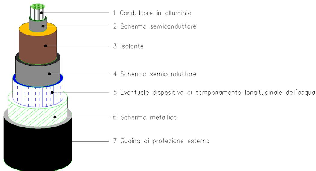
L'elettrodotto sarà costituito da due terne di cavi unipolari in alluminio per il collegamento a 36 kV AT. I cavi avranno isolamento in XLPE e saranno costituiti da conduttori in alluminio con sezioni pari a 3x1x630 mm<sup>2</sup>. I cavi saranno conduttori di tipo milliken a corda rigida, compatta e tamponata di alluminio, ricoperta da uno strato semiconduttivo interno estruso, dall'isolamento XLPE per l'AT,
