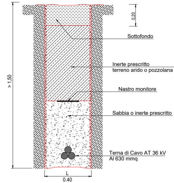
ESEMPIO DI UTILIZZO DELLA MACCHINA T.O.C. PER LA REALIZZAZIONE DELLA TRIVELLAZIONE TRASVERSALE ( SEZIONE CAVIDOTTO )
