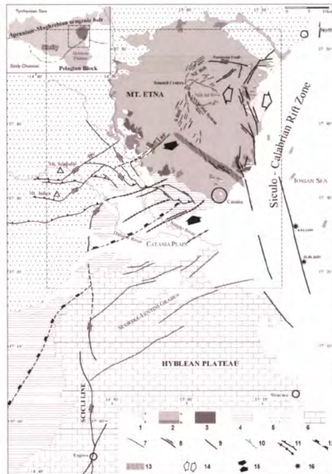
Figura 8 – Schema geologico-strutturale dell'area di Catania (da Torrisi et al. 2008). 1: a) conoide alluvionale; b) depositi alluvionali olocenici; 2: a) lave etnee recenti (< 80 ka); b) Lave centri alcalini antichi (180÷100ka); 3) Lave pre-etnee sub-alcaline (580÷250 ka); 4) depositi pleistocenici di avanfossa; 5) Unità alloctone; 6) sequenze carbonatiche iblee; 7) faglia normale; 8) faglia trascorrente; 9) segmento del Rift Siculo-Calabro; 10) fratture estensionali e fessure eruttive; 11) anticlinale e thrust; 12) fronte unità alloctone; 13) zona di faglia trasformate; 14) direzione massima estensione nell'area etnea lungo il Rift Siculo-Calabro; 15) direzione di massima compressione nell'area a sud dell'Etna; 16) epicentri dei terremoti storici con M>7.
