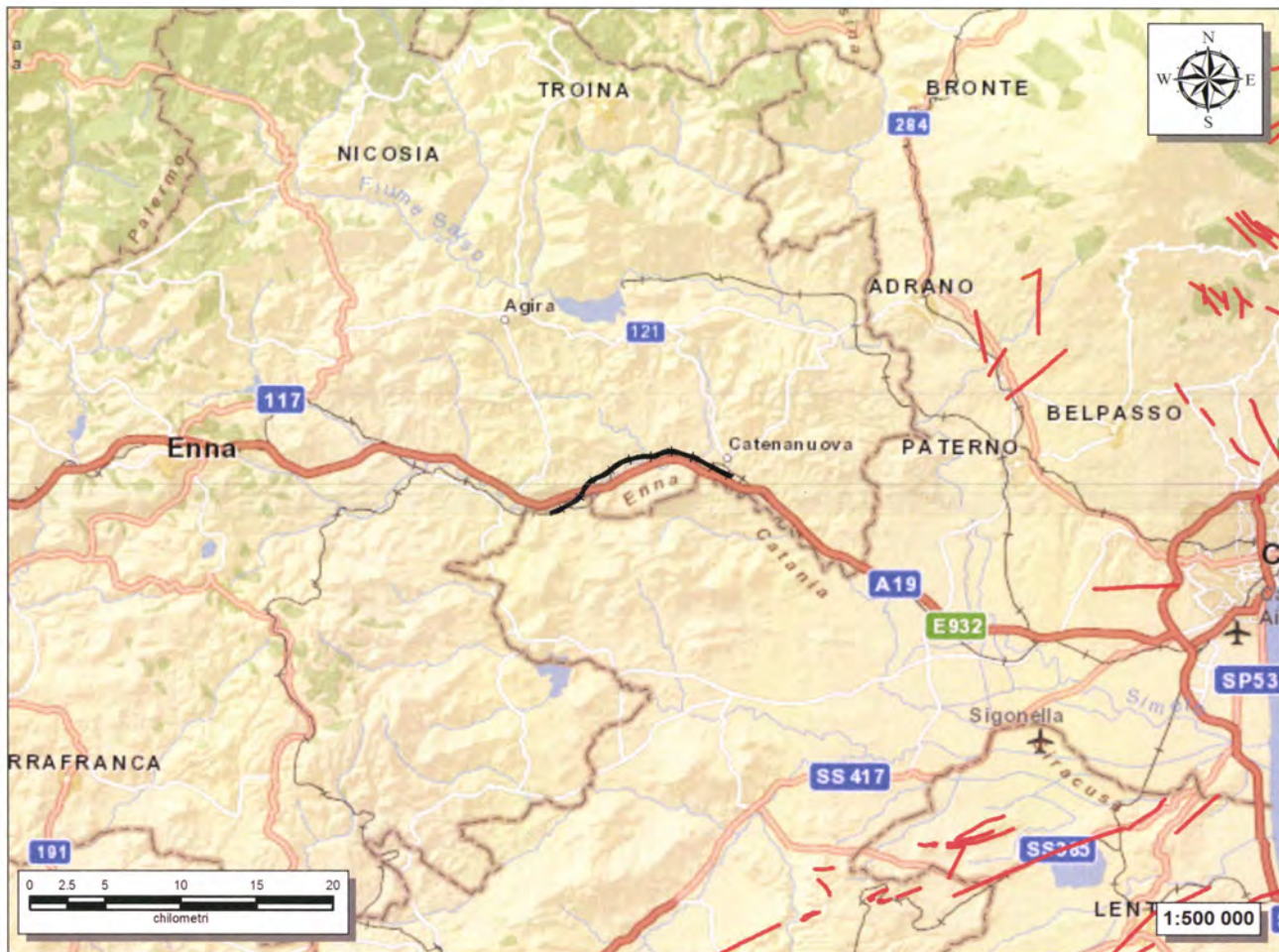
Figura 29 - Stralcio cartografico dell'area di interesse con indicazione schematica del tracciato di progetto (in nero) e delle faglie capaci (in rosso) ( http://sgi.isprambiente.it/ArcGIS/rest/services/servizi/ithaca/MapServer ).
