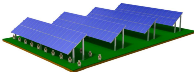
Figura 8.2: Tipologia di impianto fotovoltaico a struttura fissa.
