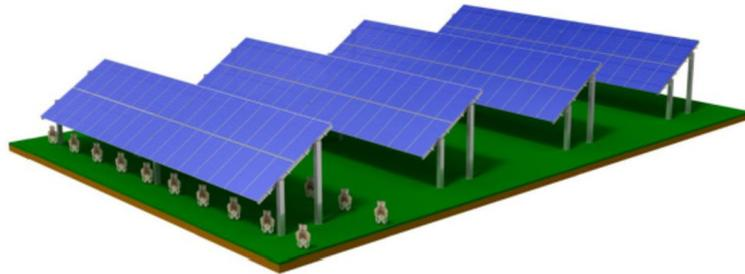
**Figura 6-2: Tipologia di impianto fotovoltaico a struttura fissa.**
