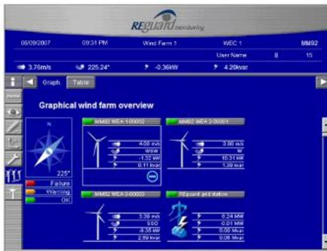
SCADA – Visualizzazione Stato del Parco Eolico.
