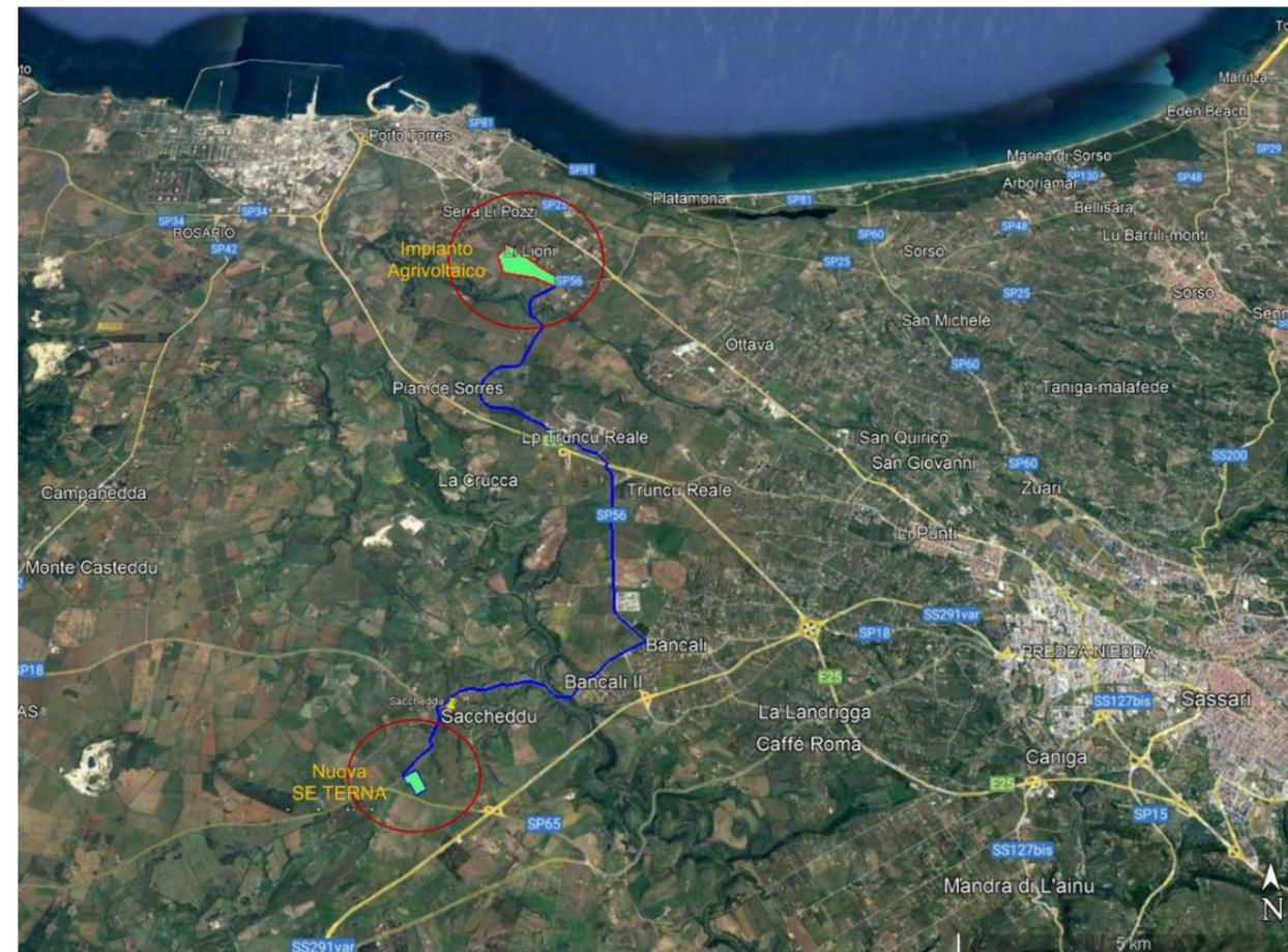
In relazione al **nuovo standard a 36 kV di TERNA** (formalizzato nel marzo 2023), l'elettrodotto termina direttamente in uno stallo in esecuzione protetta (IRC) che **TERN A renderà disponibile all'interno della nuova SE 380/150/36 kV**.
