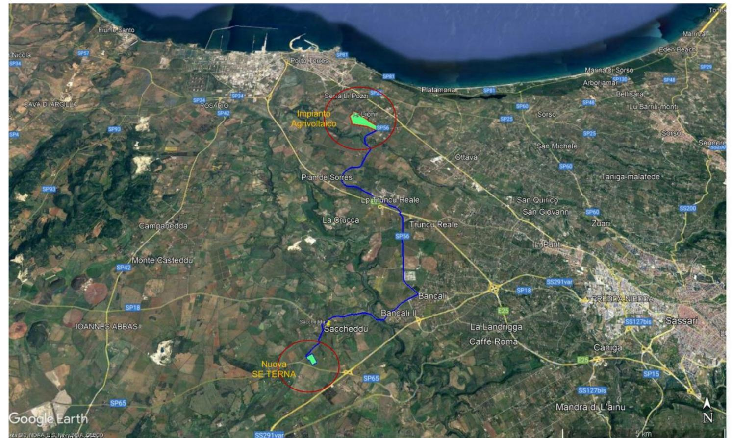
Vista su ortofoto della posizione della centrale Agrivoltaica, dell'elettrodotto di connessione a 36 kV e della posizione prevista per la nuova SE TERNA ove è prevista la connessione alla RTN
