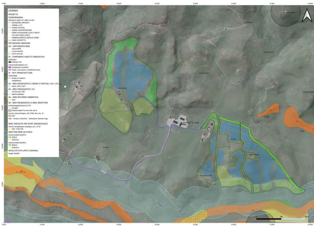
Figura 12a-12b: Inquadramento Dettaglio Impianto Agrofotovoltaico Sardegna Mappe fonti energetiche rinnovabili. Il posizionamento dei pannelli fotovoltaici dell’impianto agrosolare rispetta il vincolo dei 150 m dal fiume”. Art. 142 - Fiumi, torrenti e corsi d’acqua iscritti negli elenchi di cui al t.u. approvati con R.D. 1775/33 e le relative sponde o piedi degli argini per una fascia di 150 metri ciascuna.
