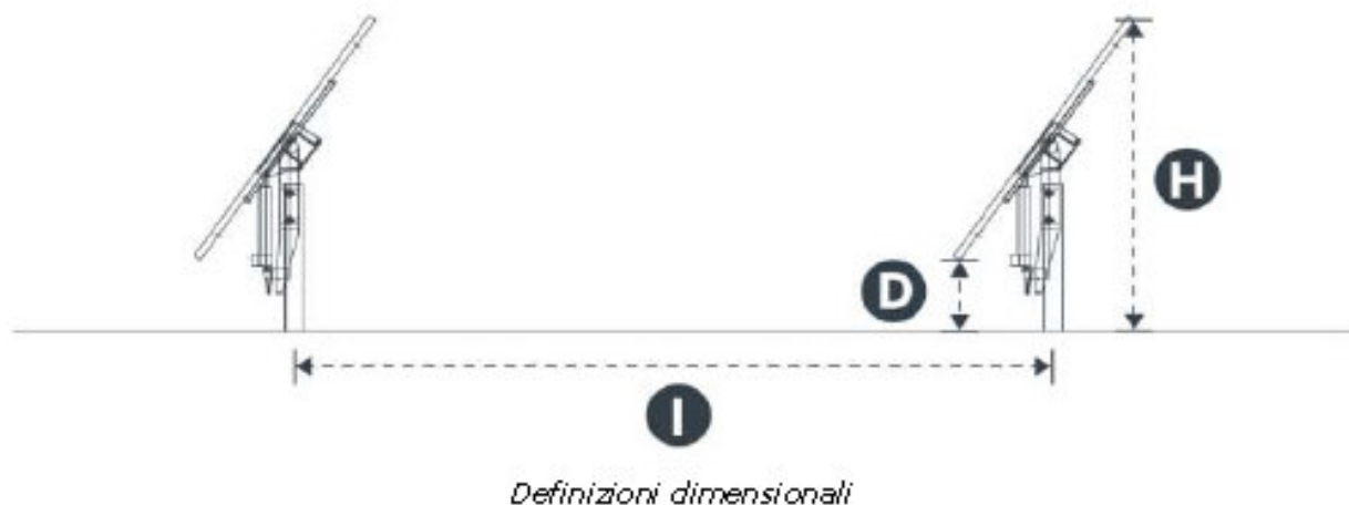
Fig. 57: Schema interasse dei sostegni fotovoltaici
