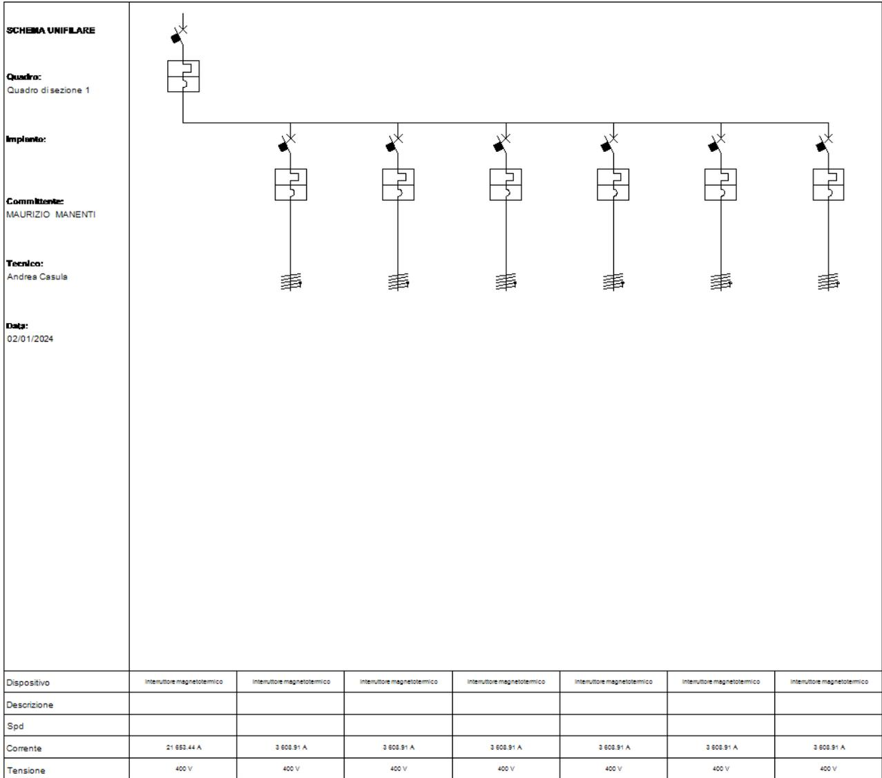
Fig. 6: Schema unifilare quadro "Quadro di sezione 1"
