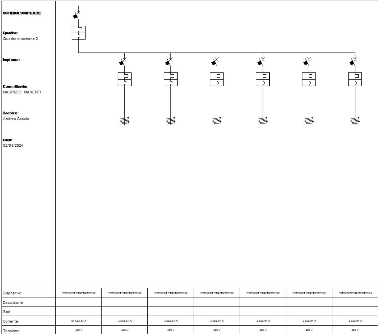
Fig. 19: Schema unifilare quadro "Quadro di sezione 2"
