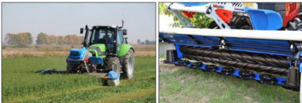
Figura14: Esempio di falciacondizionatrice frontale e particolare dei rulli in gomma
