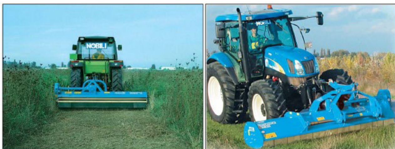
Figura13: Esempi di trincia posteriore e anteriore di notevole larghezza
