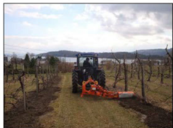
Figura 10: Esempio di fresatrice interceppo per le lavorazioni sulla fila
