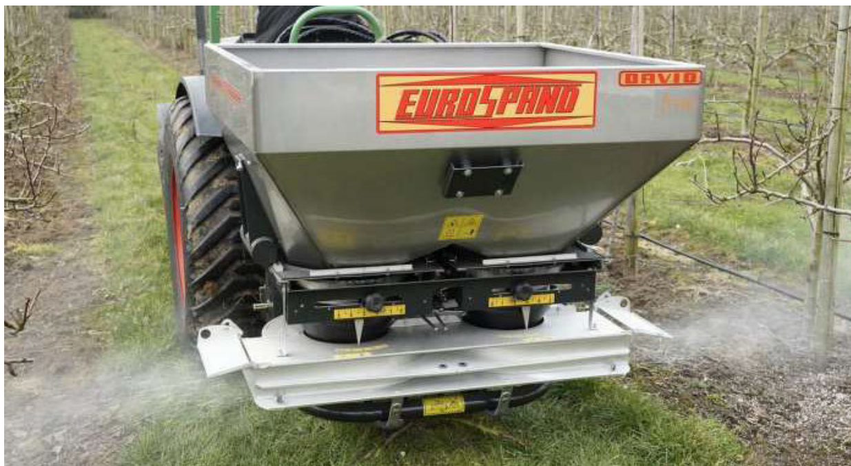
Figura 24: Esempio di spandiconcime localizzato mono/bilaterale per frutteti
