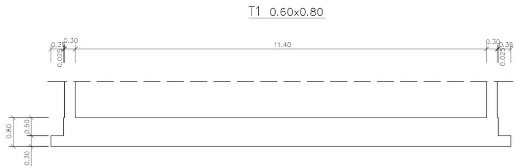
CALCESTRUZZO  $R_{ck} \geq 35 \text{ N}^2/\text{mm}$
