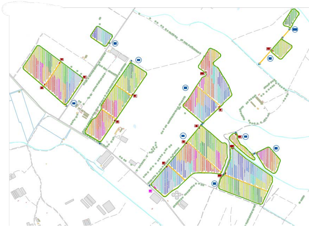
Figura 5- Particolare schema di suddivisione stringhe impianto
