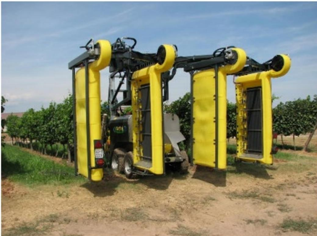
*Figura 14 - Vista di atomizzatore con barre per il recupero della deriva dei prodotti fitosanitari*
