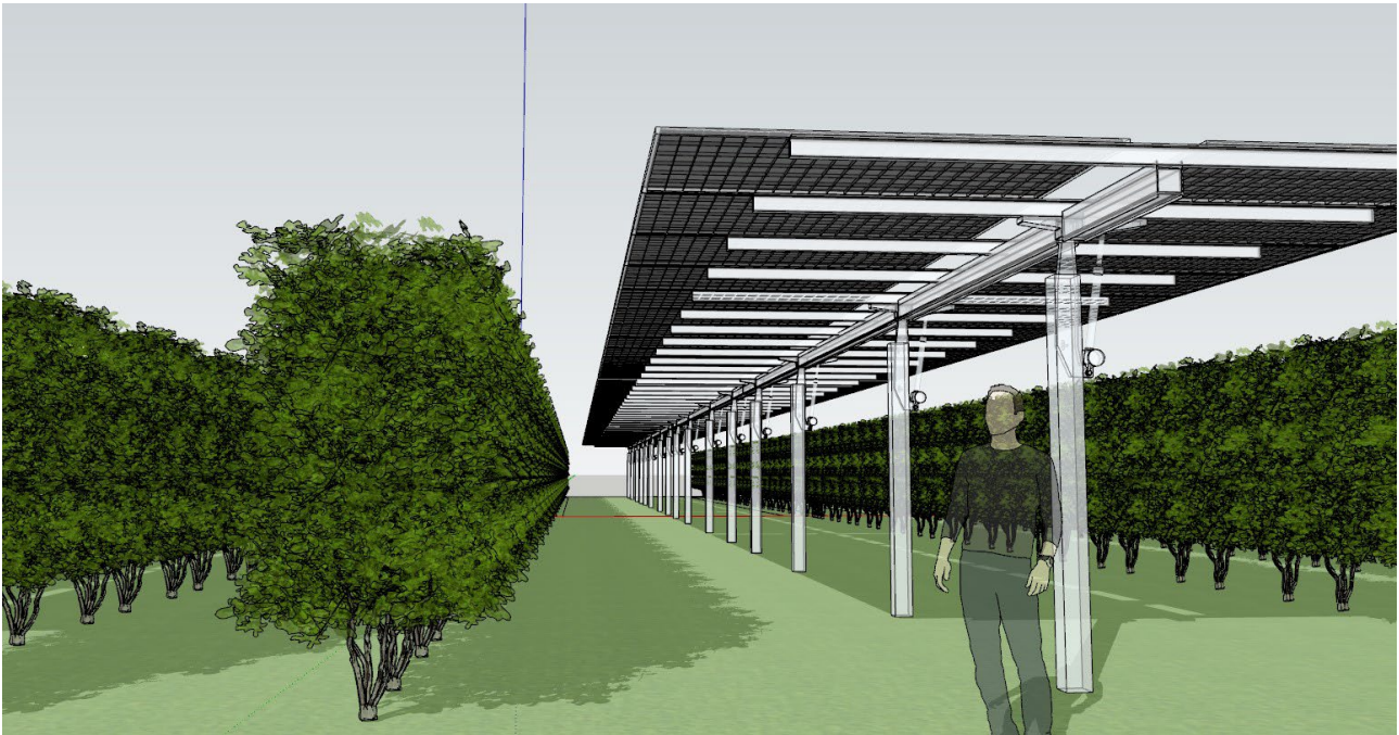
Figura 4 - Immagine impianto, altezza media 2,8 mt
