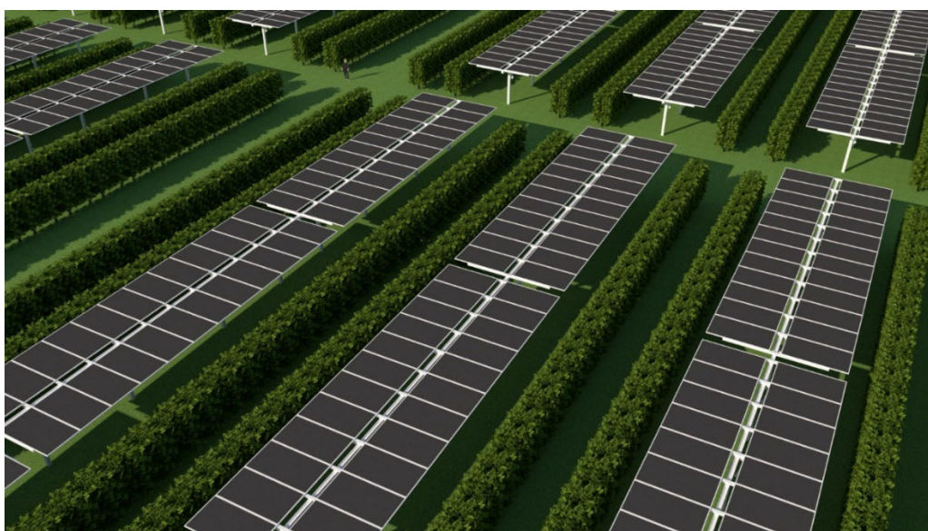
Figura 9 - Schizzo dell'assetto impiantistico: un filare FV e due siepi ulivicole alternate
