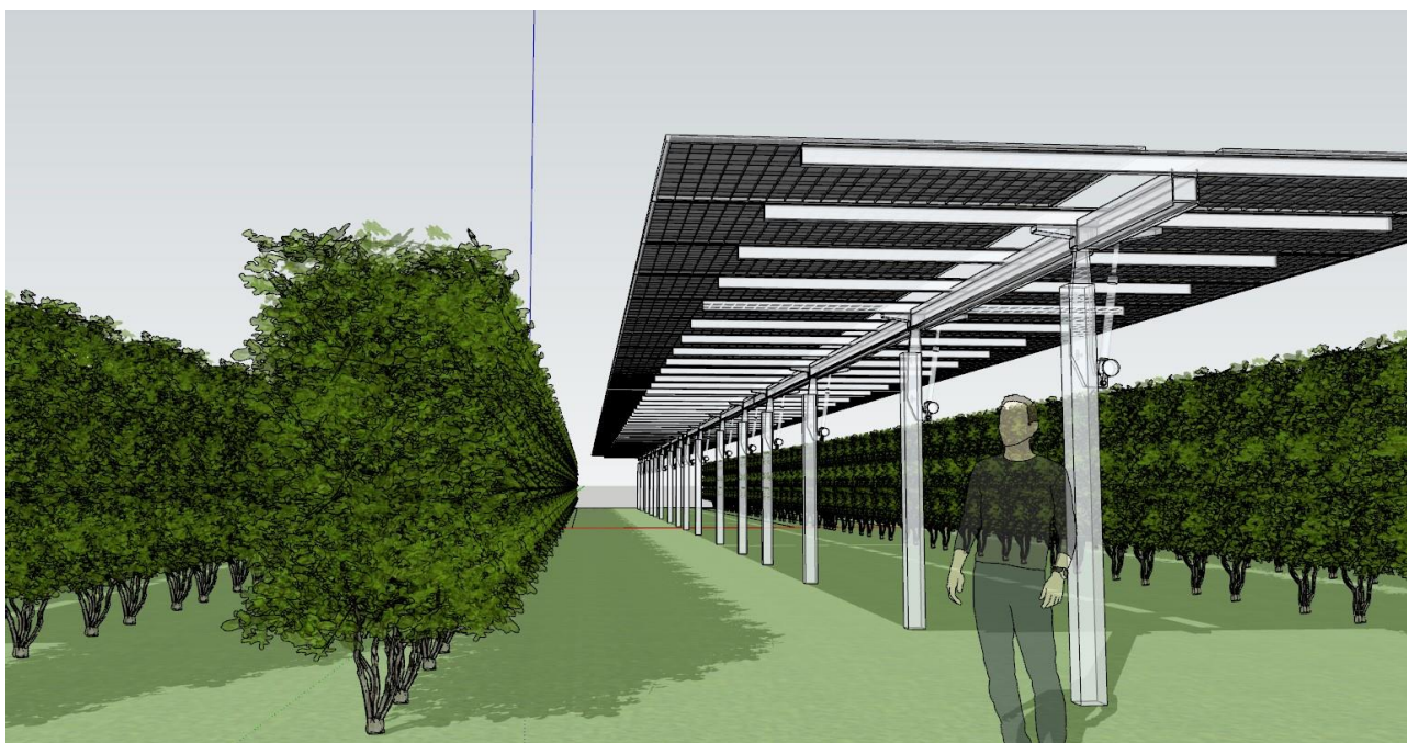
Figura 8 - Immagine impianto, altezza media 2,8 mt
