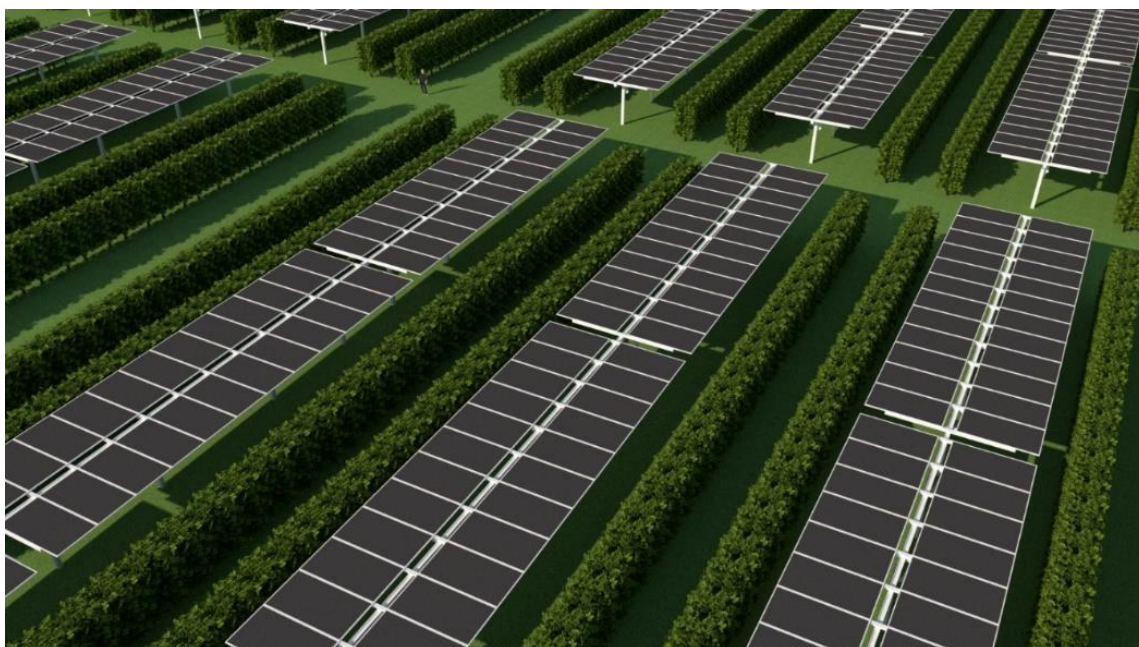
Figura 101 - Particolare del modello, siepi ulivicole e tracker in posizione orizzontale
