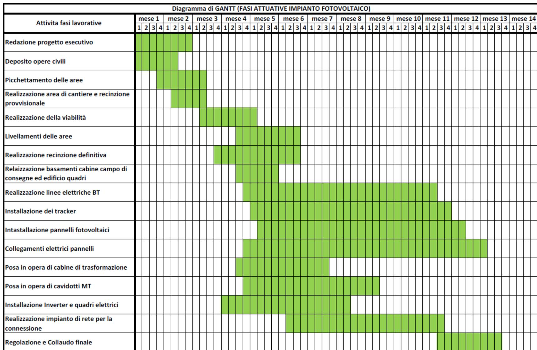
Figura 2- Cronoprogramma delle fasi attuative della realizzazione impianto fotovoltaico denominato Alberona1
