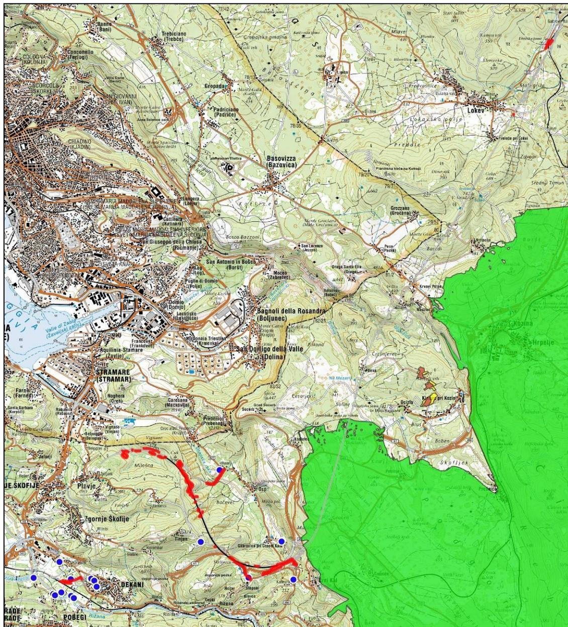
Figura 68: Area di protezione delle acque della sorgente del Risano e permessi idrici (cerchio blu) entro 500 m dalle modifiche previste e all'integrazione del piano. L'area rossa mostra le sistemazioni per il previsto binario sinistro della nuova linea Divača-Capodistria. Il tracciato del tunnel più lungo T3-6L è indicato in nero.
