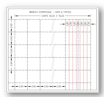
In tutte le zone dove vi è la presenza di una falda superficiale prossima al piano campagna (si veda cap.3) la bonifica dovrà essere condotta mediante apposita strumentazione e, qualora siano necessari scavi di approfondimento, provvedere al prosciugamento del terreno mediante l'impiego di pompe idrovore e l'eventuale realizzazione di pozzi di drenaggio.
