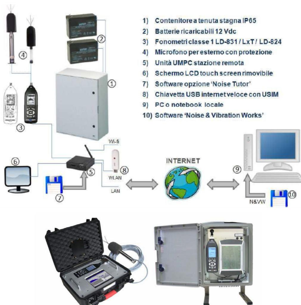
Componenti sistemi di monitoraggio real time
