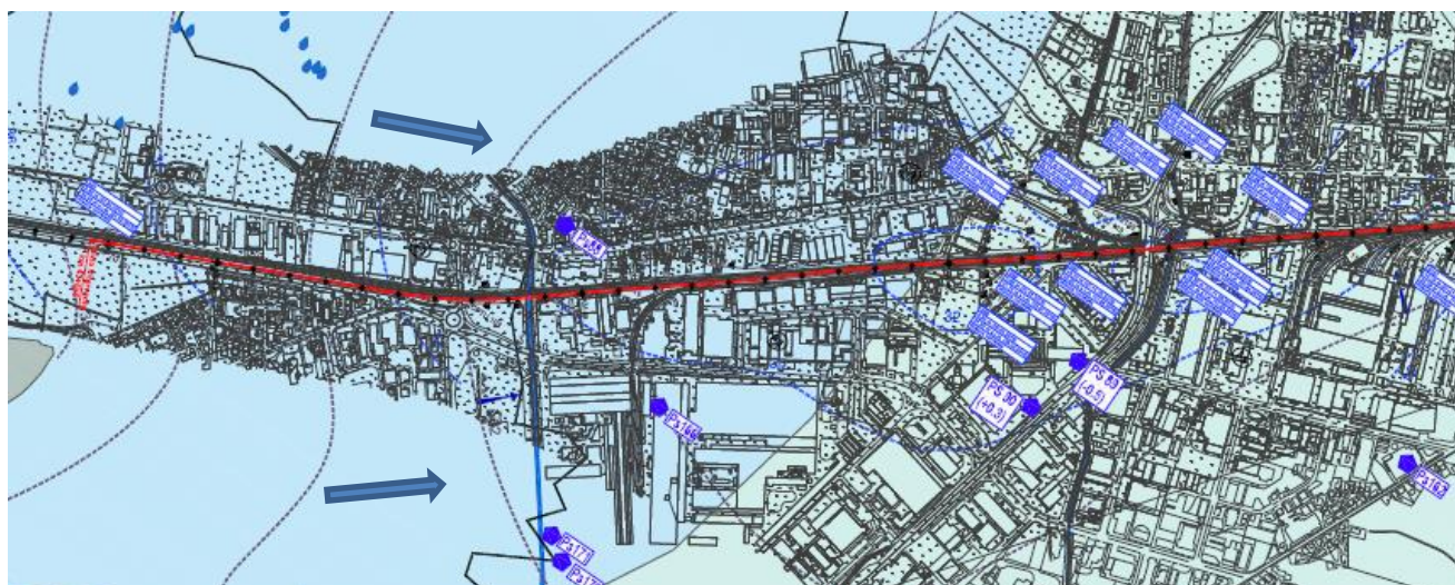
Figura -3 – Stralcio della carta idrogeologica del progetto preliminare. Esempio della direzione del flusso idrico sotterraneo e isofreatiche lungo la prima porzione del tracciato
