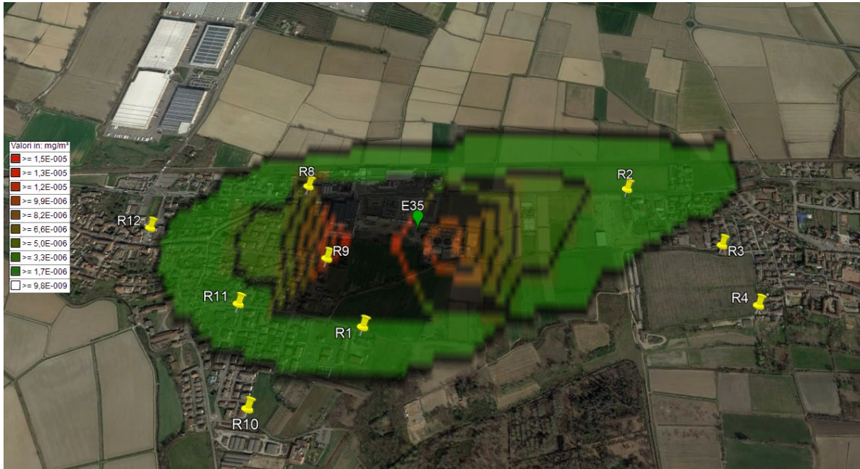
Immagine 12.9: Mappa Iso Concentrazione HCl. Valori medi in ogni recettore calcolati sulla media di 1 hr
