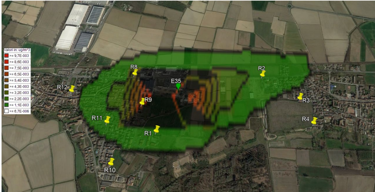
Immagine 12.7: Mappa Iso Concentrazione PM 10 . 90,4 Percentile in ogni recettore calcolati sulla media di 24 hr
