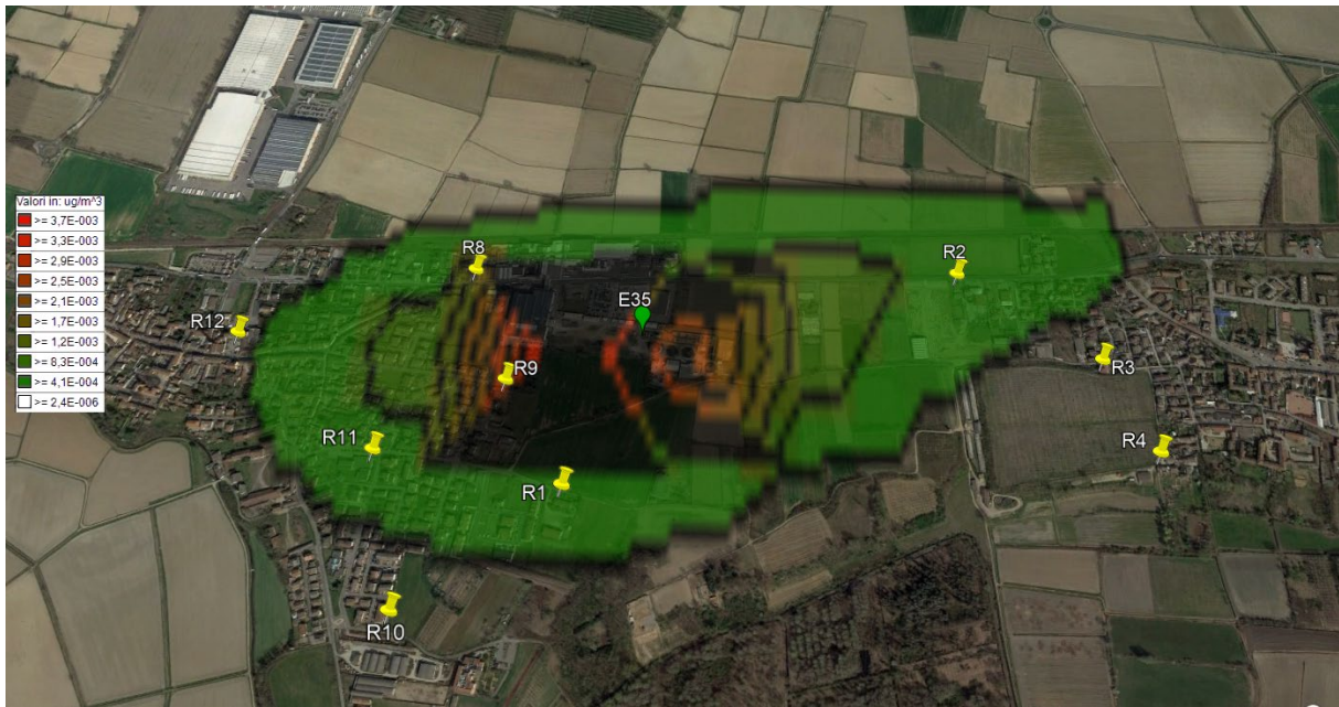
Immagine 12.8: Mappa Iso Concentrazione PM 2.5 . Valori medi in ogni recettore calcolati sulla media di 24 hr
