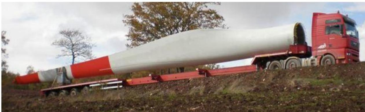
**Figura 3. Mezzi per il trasporto della pala.**
