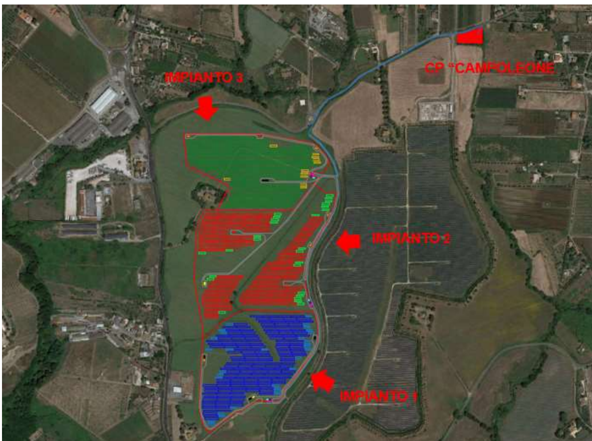
Figura 1 – Sovrapposizione su ortofoto del layout di impianto con indicazione del collegamento alla Cabina Primaria "Campoleone" e dei tre impianti costituenti il lotto
