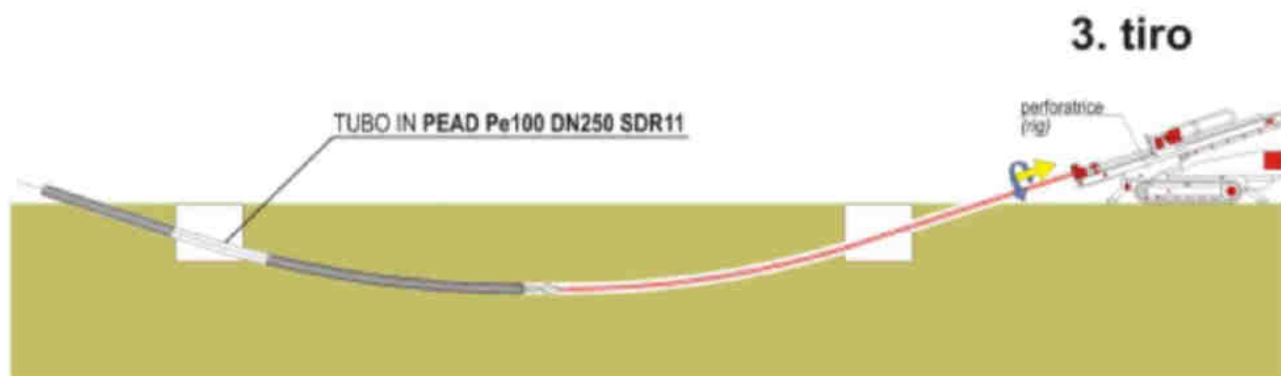
Figura 3. Schema esempio della fase di posa del cavidotto (Pull-Back)
