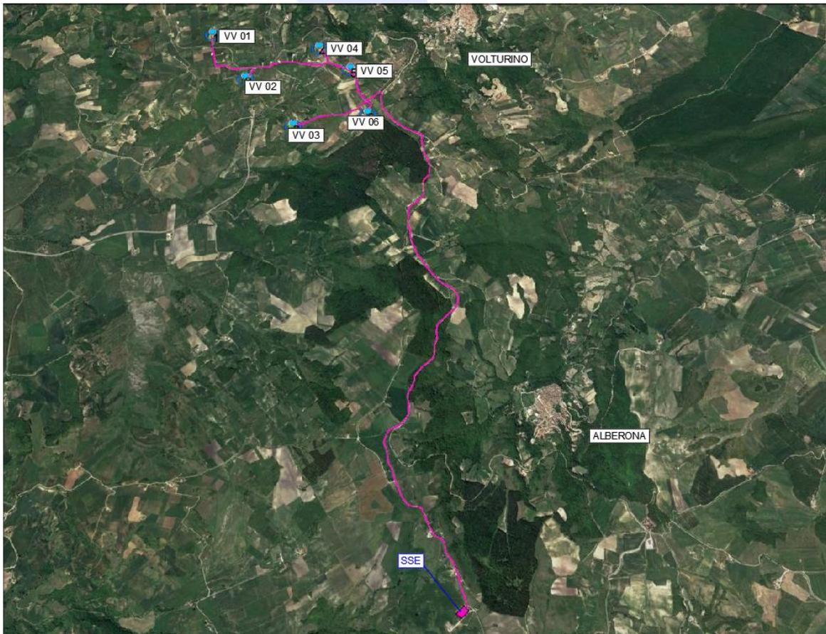
**Fig. 1** – Inquadramento su ortofoto del parco eolico: in viola è rappresentato il cavidotto interrato MT, in ciano la posizione degli aerogeneratori.
