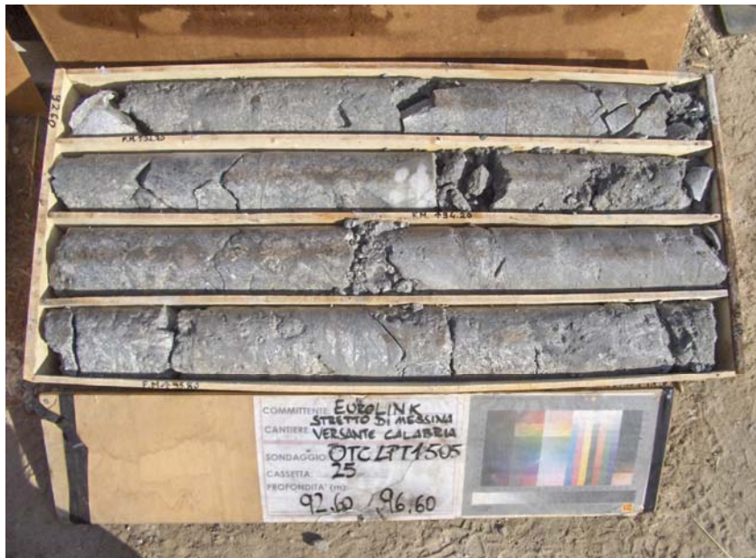
Fig.3.9 – Carote di Conglomerato di Pezzo ad elevato grado di cementazione dei clasti, ottenute dai sondaggi C406 e OTC_LPT1_505 (rispettivamente in alto ed in basso).
