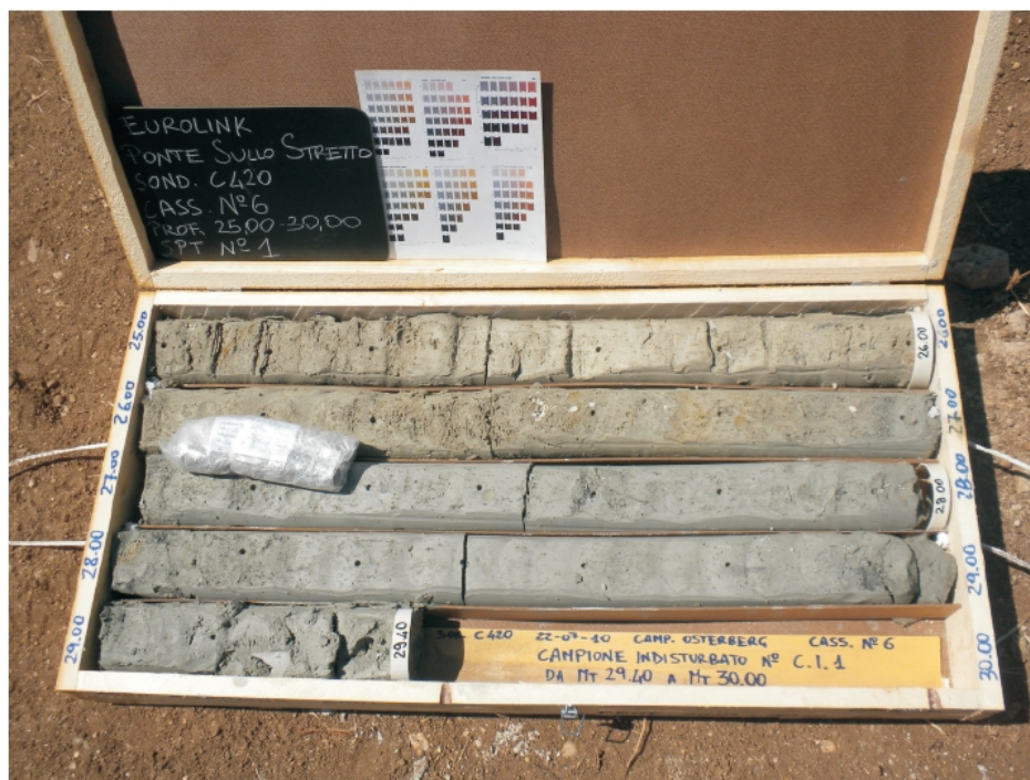
Fig. 3. 16 – Marne della Formazione dei Trubi, carotate dal sondaggio C420
