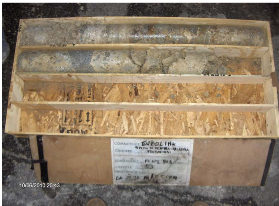
Fig. 3.24 – Carote di Calcareniti di S.Corrado ottenute dai sondaggi FC_SPT_503 in facies bioclastica e brecciata (rispettivamente foto in alto ed in basso).
