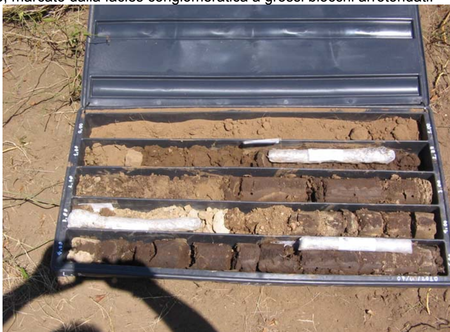
Fig. 3.31 – Carote di depositi di terrazzo marino ottenute dal sondaggio C428; è evidente la presenza di livelli limosi, più sciolti, e di livelli argilloso-limosi, più coesivi.
