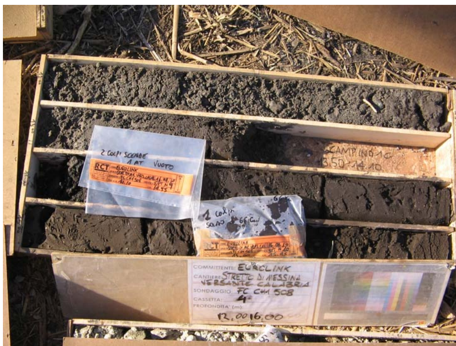
Fig. 3.37 – Argille con torba carotati nei depositi di piana costiera nel sondaggio FC_CH1_508. In corrispondenza del tratto di piana costiera di interesse per l'intervento non sono mai state rinvenute in sondaggio Ghiaie e Sabbie di Messina al di sotto dei depositi costieri olocenici che,
