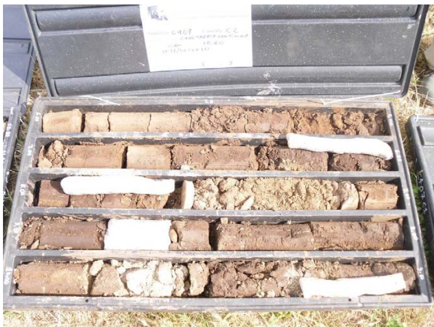
Fig. 3.38 – Carote di depositi detritici di versante clinostatificati ottenute dal sondaggio C407.
