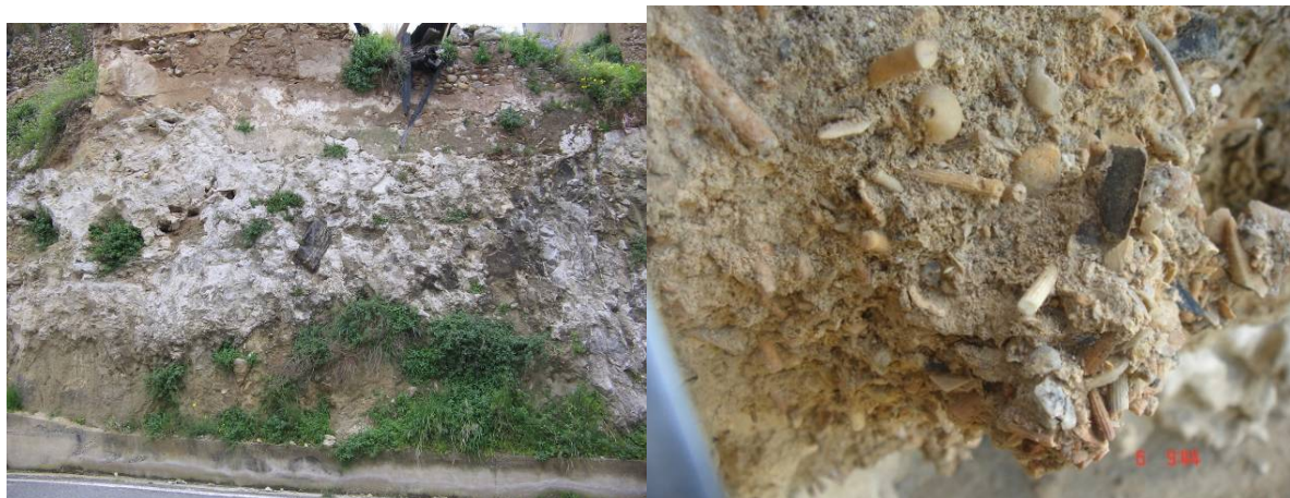
Fig. 3.22 - Dettagli di affioramenti della Formazione di S. Corrado in cui è ben visibile l'abbondante contenuto bioclastico (foto di destra) e la presenza, a luoghi, di blocchi cristallino-metamorfici cementati da matrice micritica (foto di sinistra).
