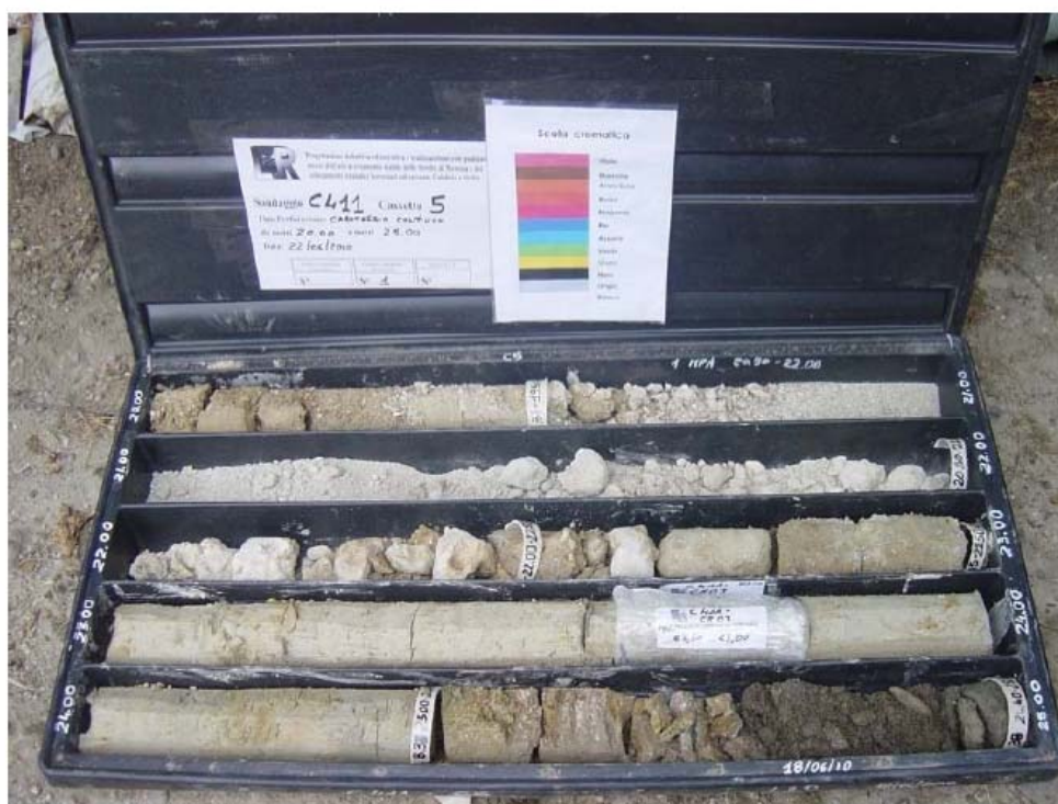
Fig. 3.17 – Contatto tra Trubi e Conglomerato di Pezzo osservato nel sondaggio C411 a circa 25m dal p.c.. Si notano sovrapposte la facies calcarenitica e quella marnosa dei Trubi nell'intervallo di profondità 22-25 m dal p.c..
