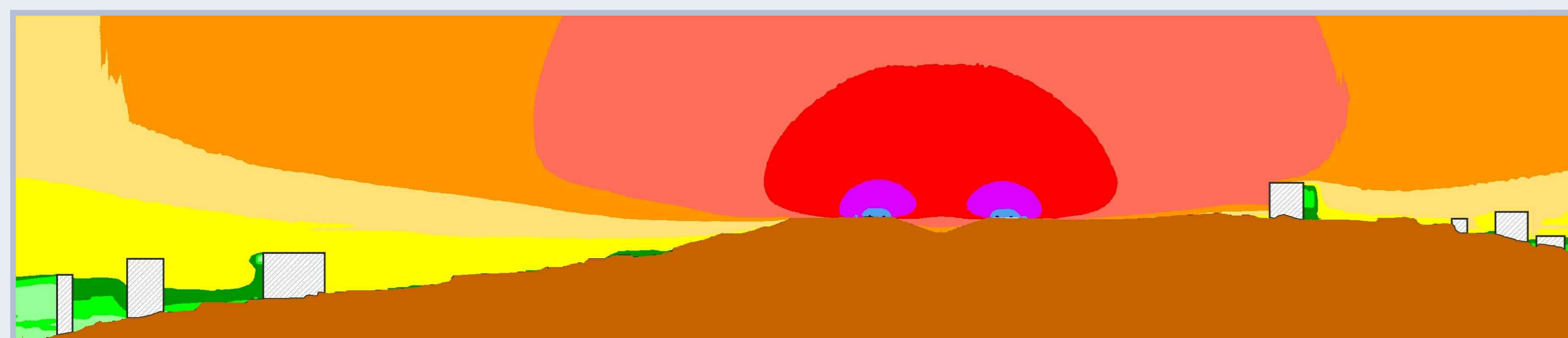
IMPATTO STRADALE - SEZIONE ANTE MITIGAZIONE - Leq(22-6)
