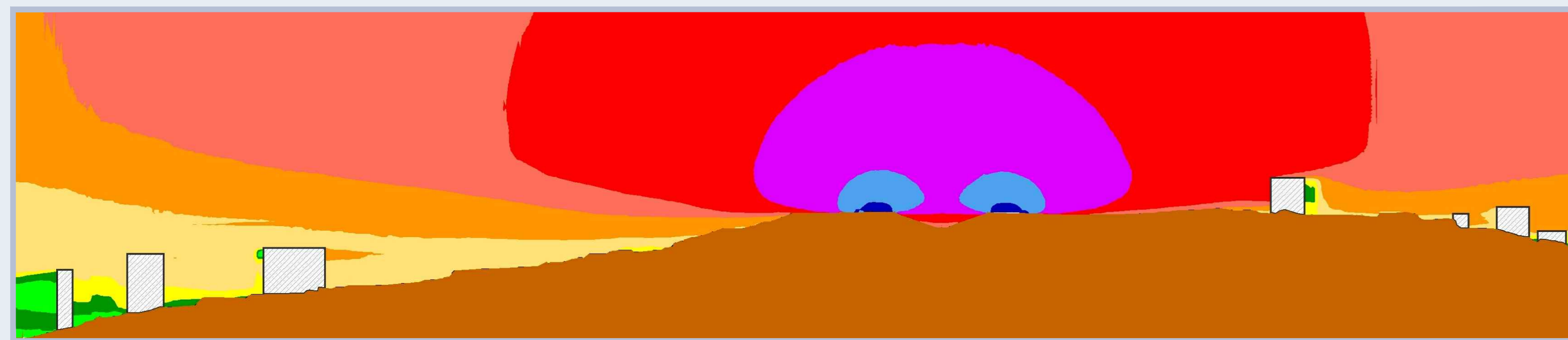
IMPATTO STRADALE - SEZIONE ANTE MITIGAZIONE - Leq(6-22)
