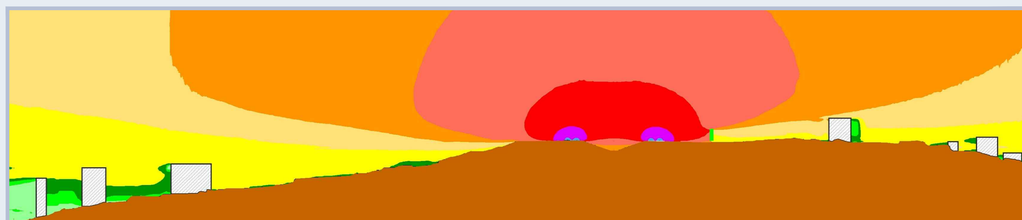
IMPATTO STRADALE - SEZIONE POST MITIGAZIONE - Leq(22-6)
