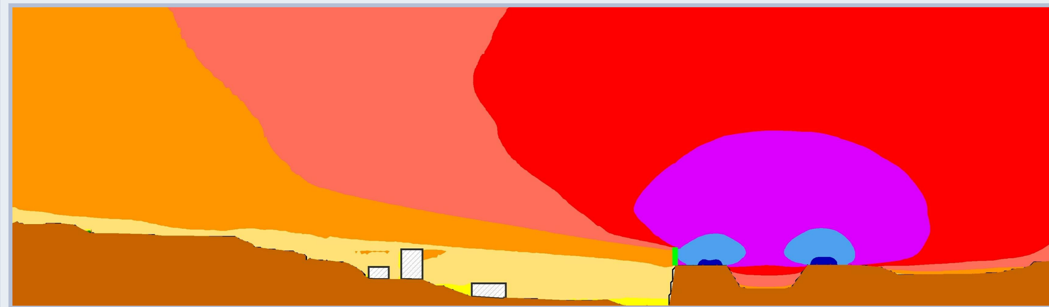
IMPATTO STRADALE - SEZIONE POST MITIGAZIONE - Leq(6-22)
