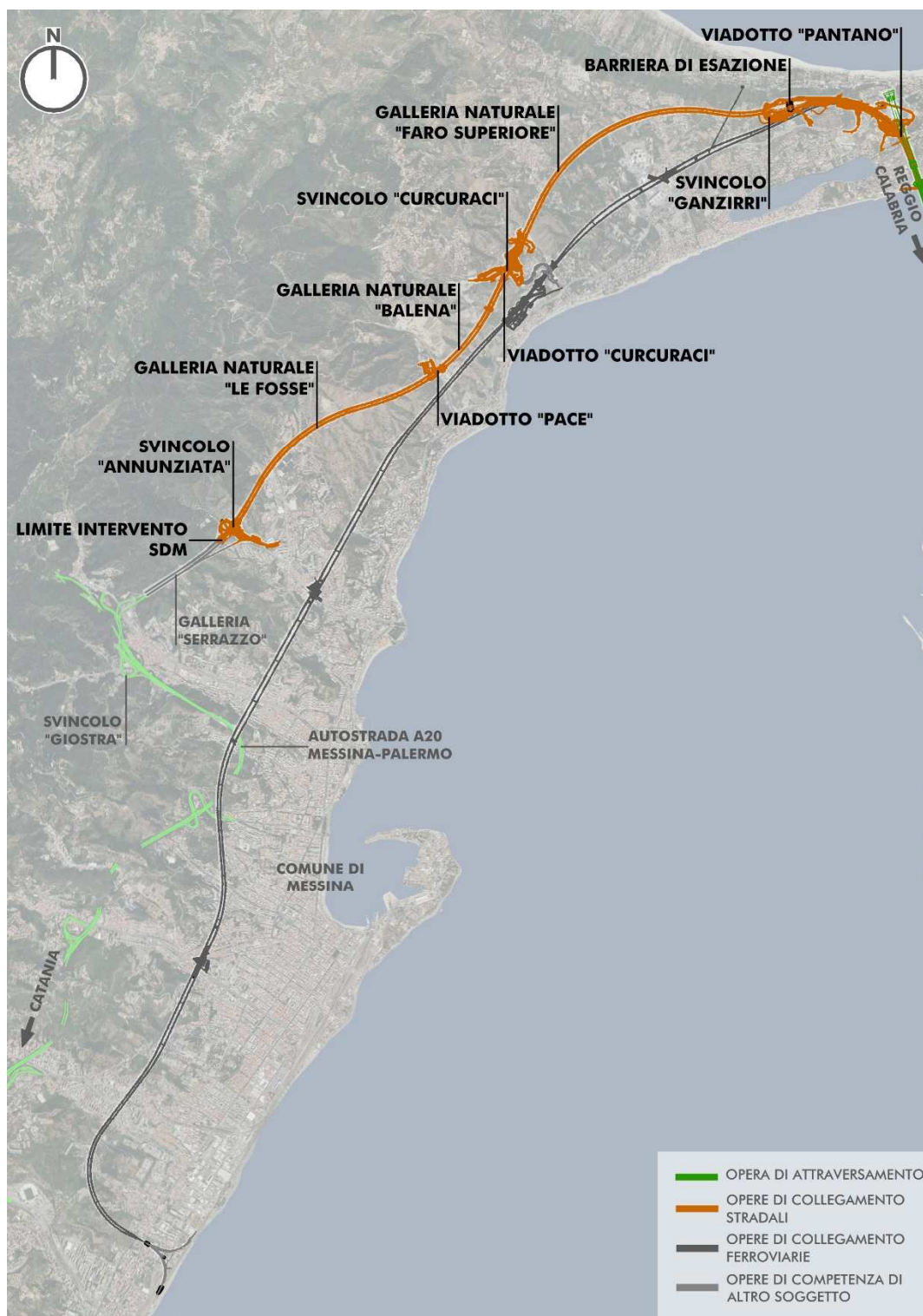
Figura 1.18 – Stralcio planimetrico con indicazione dei principali elementi di progetto costituenti i collegamenti stradali sul versante Sicilia
