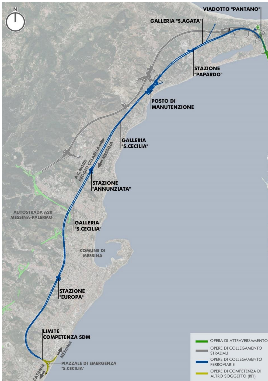
Figura 1-14 Stralcio planimetrico con indicazione dei principali elementi costituenti i collegamenti ferroviari di progetto sul versante Sicilia
