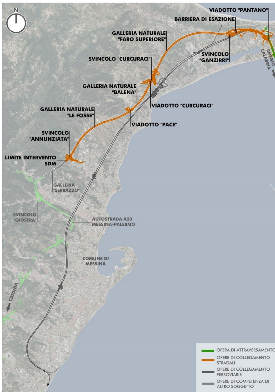
Figura 1-11 Stralcio planimetrico con indicazione dei principali elementi di progetto costituenti i collegamenti stradali sul versante Sicilia
