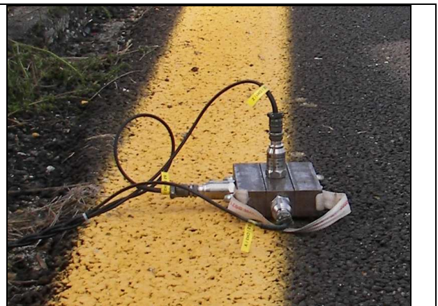
Figura 3.33 Massetto metallico con terna di accelerometri
