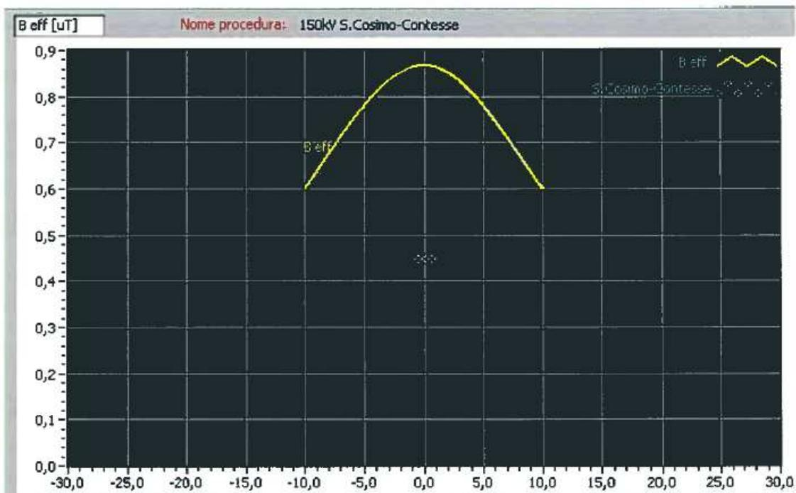
Figura 3.62 – Profilo laterale campo magnetico per i punti situati sul piano stradale con profondità di posa pari a -15 m
