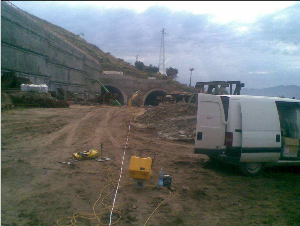
Figura 2. Energizzazione con fucile sismico e stazione sismica.
